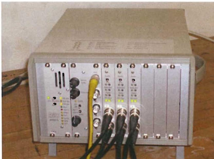
Abbildung 18: AMSY-5 Master Unit mit 6 Steckplätzen, 6 Breitbandmikrophone, Verstärker und Messwandler
