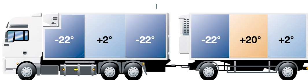
Abbildung 3.1: Schema eines Multitemperaturzonen LKWs
