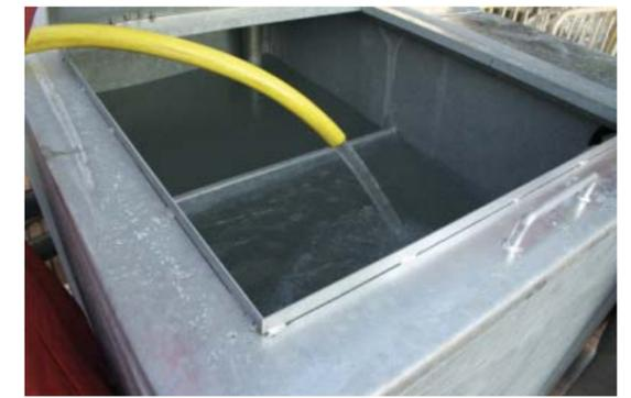
23 Puffertank mit Wasser und Frostschutzmittel
