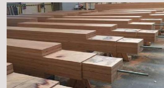
Abb. 39: Vorgefertigte Stützen
