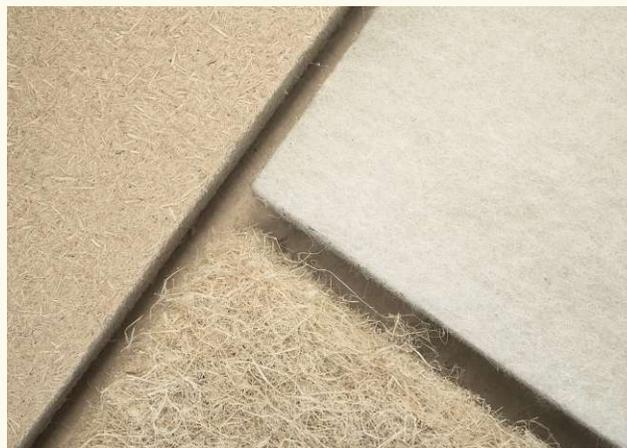
Abb. 52, unterschiedliche Dämmplatten aus Hanf
