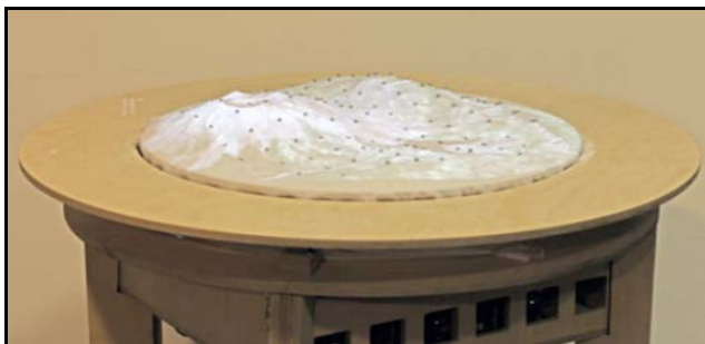
Abb. 2.23 Das Relief-System mit übergespannter Lycra und projizierter Landschaft [LEI 2010].
