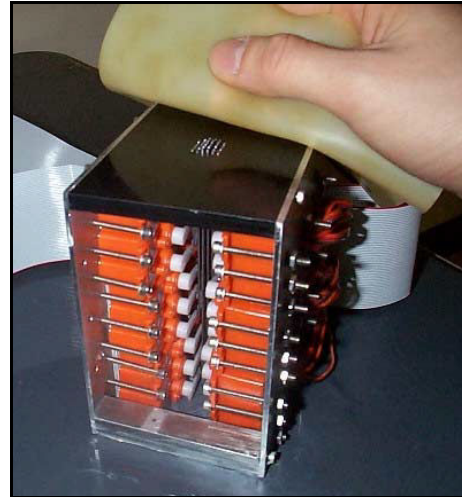
Abb. 2.14 Das taktile Shape Display [WAG 2002].
