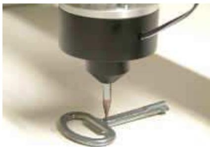
Wie der Name schon sagt wird bei dieser Methode das zu scannende Objekt „abgetastet“. Die Bezeichnung Touch Probe kann mit „Tastkopf“ übersetzt werden.
