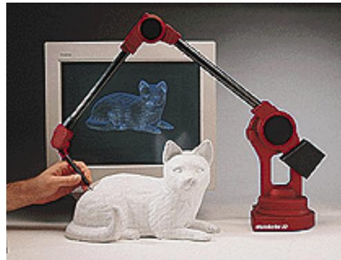
Um die Daten verlustfrei aufnehmen zu können benötigen Mechanical Probe 3D-Scanner Dauerkontakt mit der zu scannenden Oberfläche des Objektes. Scannerarme dienen als Hilfsinstrumente beim Scannen. Diese lassen viele Bewegungen, aufgrund der einzelnen beweglichen Glieder, zu und sind deswegen sehr flexibel.
