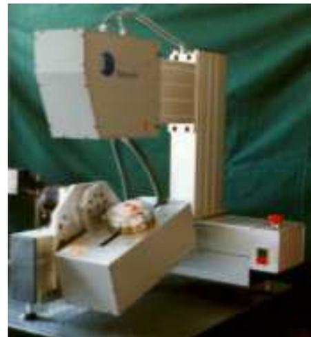
Triangulation bedeutet Abstandsmessung durch Winkelberechnung. Bei dieser Messtechnik projiziert ein Sensor einen Laserpunkt auf das Messobjekt. Unter einem bestimmten Winkel trifft das dort reflektierte Licht abhängig von der Entfernung auf ein Empfangselement. Durch die Distanz vom Sender zum Empfangselement und die Position des Lichtpunktes auf dem Empfangselement wird der Abstand zu dem Messobjekt im Sensor berechnet.
