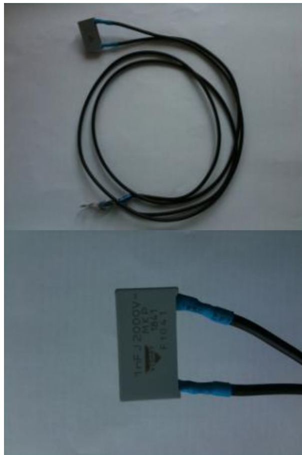
Abbildung 6.1: Kapazität von 1nF mit angelöteten Verbindungskabel
