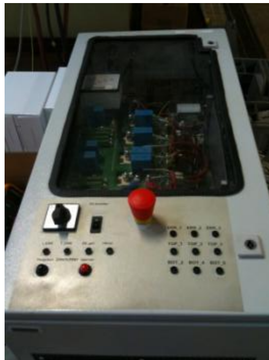
Abbildung 3.4: Der verwendete Pulswechselrichter aus dem Maschinensaal, Prüfstand 1
