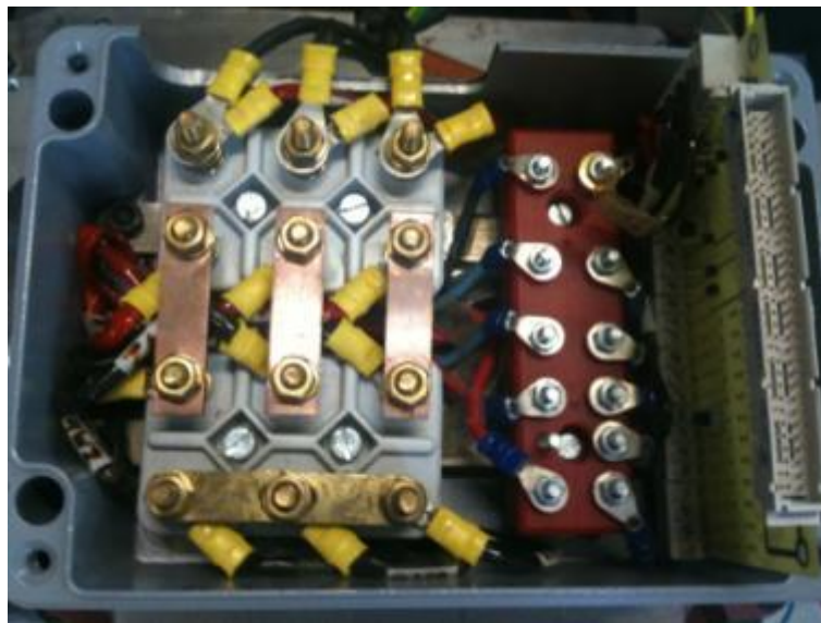
Abbildung 3.3: Klemmbrett der ASM mit herausgeführten Windungsanschlüssen
