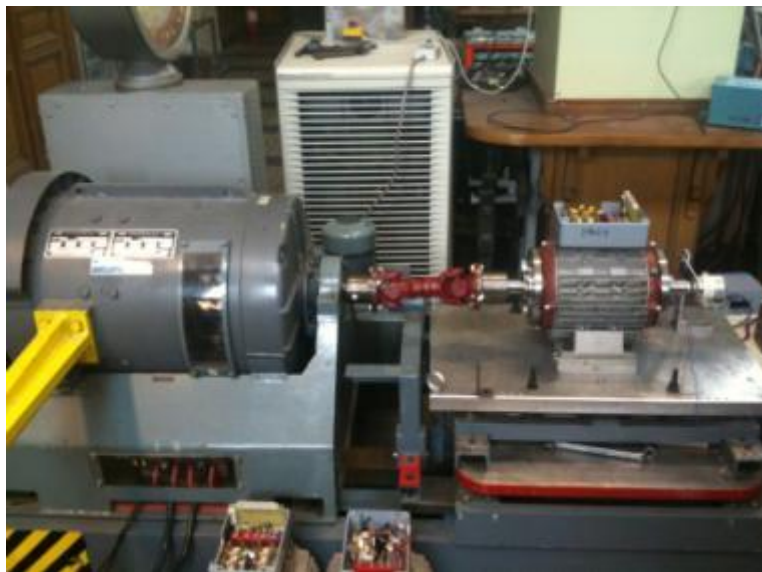
Abbildung 3.1: Gleichstrommaschine mit gekoppelter Asynchronmaschine (Versuchsmaschine)
