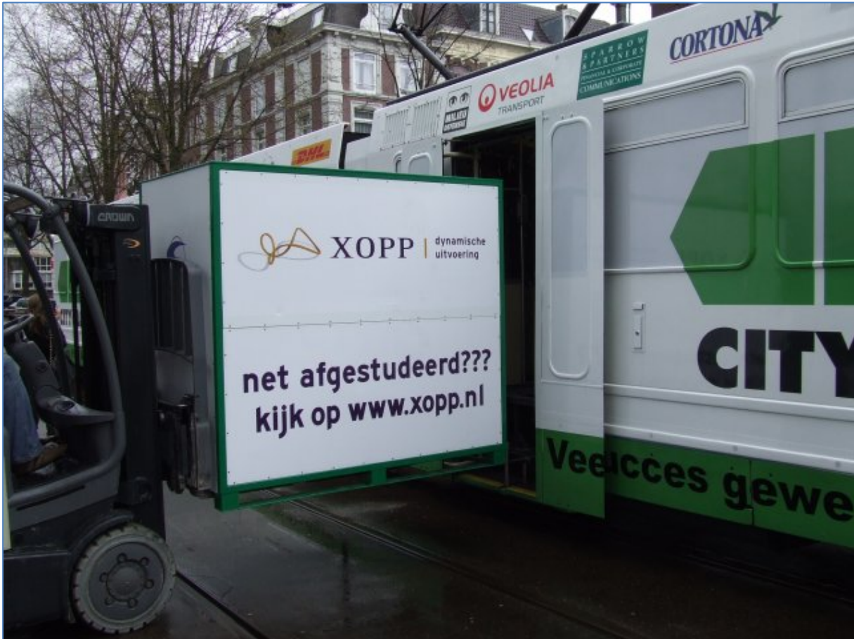
Abbildung 9: Beladung der CityCargo Tram mit einem speziellen Container, Amsterdam
