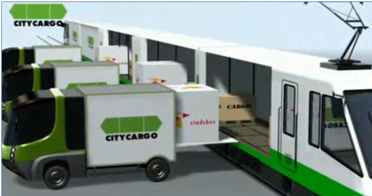
Abbildung 7: Konzeption des Umladevorgangs der CityCargo Tram in der Innenstadt, Amsterdam
