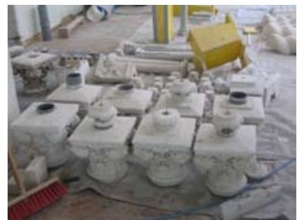
Abb. 5.71-72: Neu gegossene Fassadenelemente und Gussmodellen
