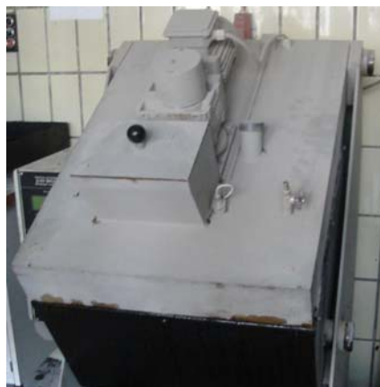
Abb. 5-25: Labormischer für Asphalt
