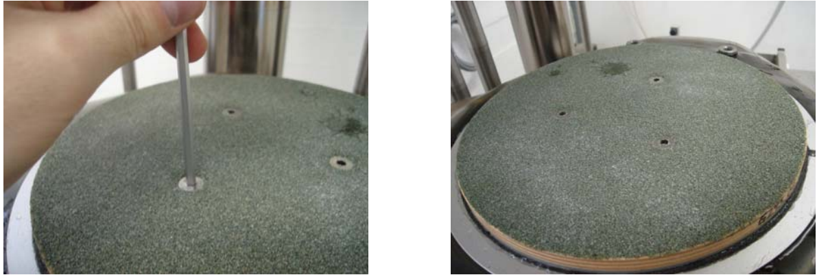
Abb. 5-12: Einbauen der Sandprobeplatte
