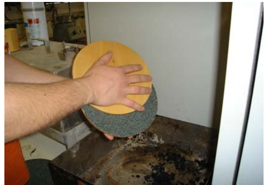
Abb. 5-9: Lösen der Isolierbänder und Entfernen des lose anhaftenden Gesteins
