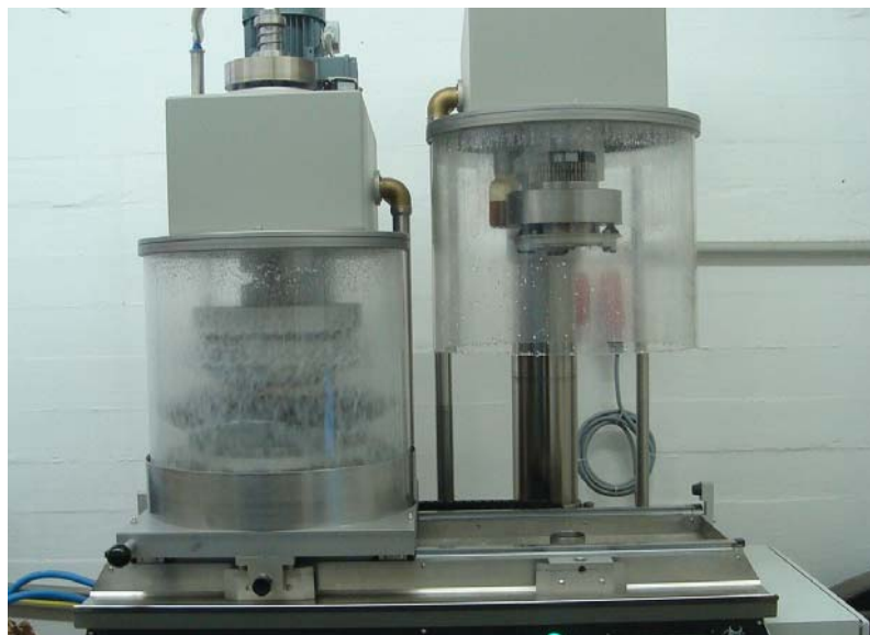
Abb. 5-13: Poliervorgang unter konstanter Zugabe von Q/W-G
