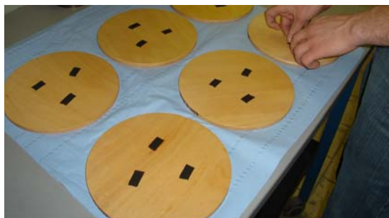
Abb. 5-4: Abkleben der Bohrlöcher an der Unterseite der Platten mit Isolierband
