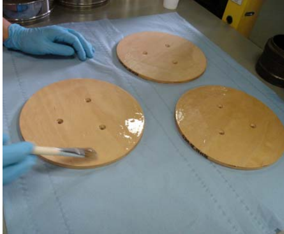
Abb. 5-5: Kleberauftragung und Verteilung
