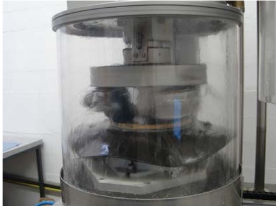
Abb. 5-14: Spülen der Probeoberfläche von Poliermittel und Sandabrieb
