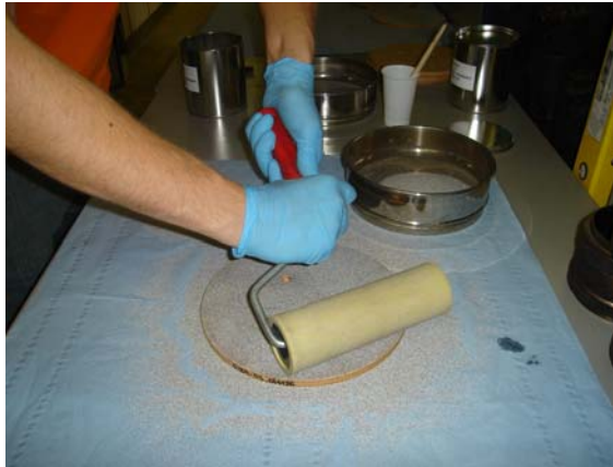
Abb. 5-7: Sand mittels Walzen im Klebebett eindrücken
