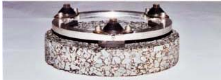
Abb. 4-7: Prinzip der Griffigkeitsmessung nach Wehner/Schulze mit der LGM (Huschek, 2002)
