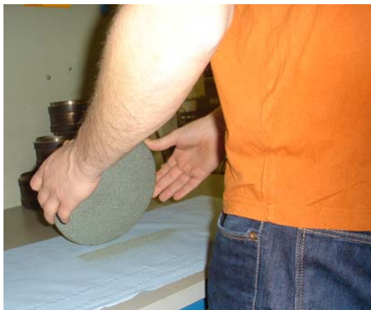
Abb. 5-8: Entfernen der überschüssigen Sandmenge
