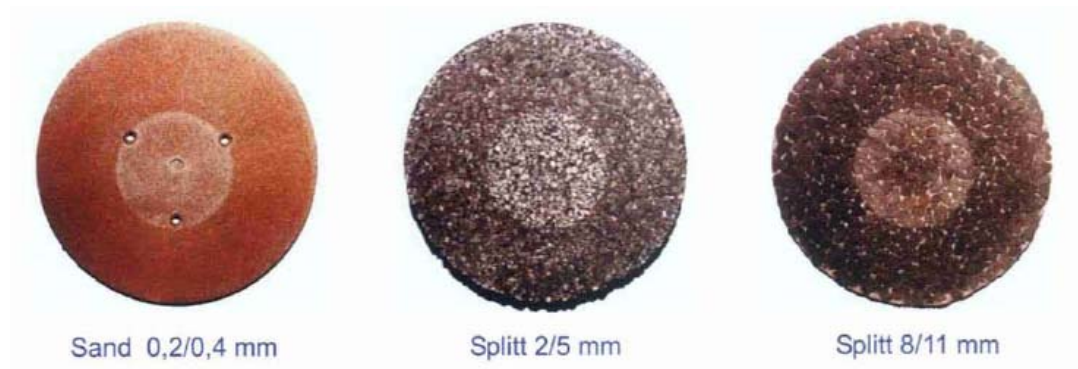
Abb. 4-4: Oberflächen zur Prüfung auf Polierresistenz nach Wehner/Schulze (Huschek, 2002)
