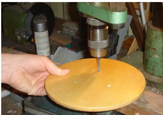
Abb. 5-10: Bohrlöcher vom aufgeklebten Sand befreien
