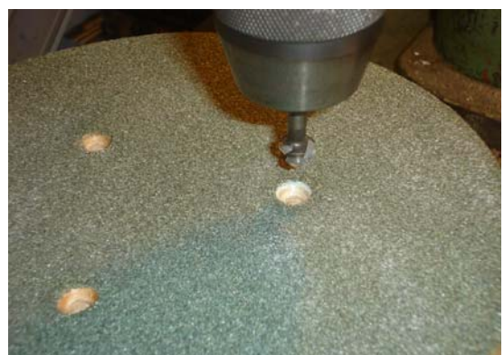
Abb. 5-10: Bohrlöcher vom aufgeklebten Sand befreien
