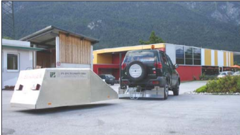
Abbildung 15: Rollgeräuschmessanhänger von IFS Ziviltechniker GmbH [19]
