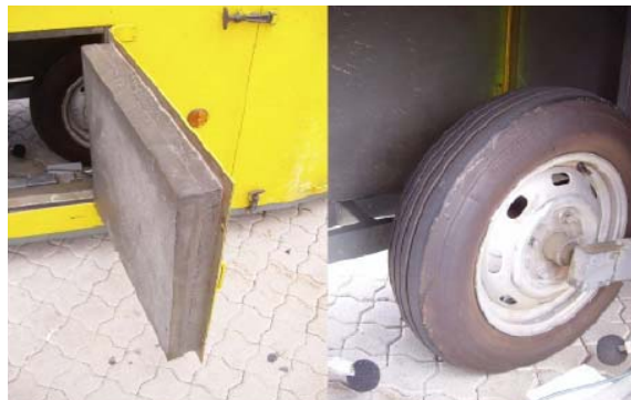
Abbildung 12: Schallabsorbierende Auskleidung des Anhängers zur Rollgeräuschmessung [17]
