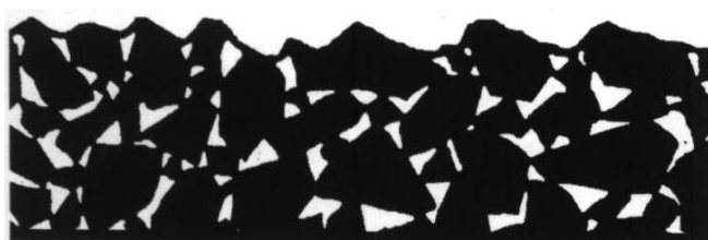
Abbildung 34: Schema des Splittmastixgerüsts [28]
