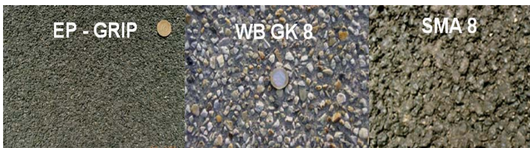
Abbildung 24: Texturoptimierte dichte Deckschichttypen: EP-GRIP (oberflächenbehandelte Betondecke), Waschbeton und Splittmastixasphalt [9]
