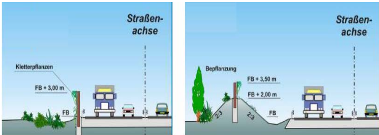
Abbildung 38: Arten von Lärmschutzeinrichtungen [32]
