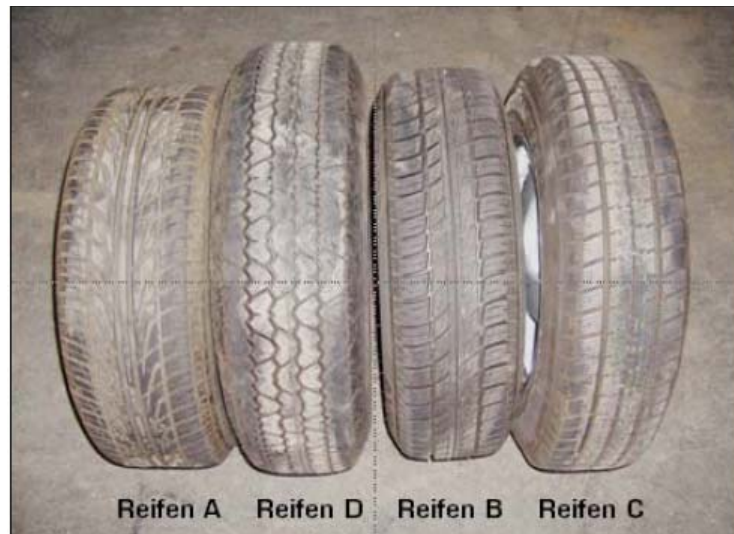
Abbildung 17: Gemäß ISO/CD 11819-2 verwendete Testreifen von IFS Ziviltechniker GmbH [19]
