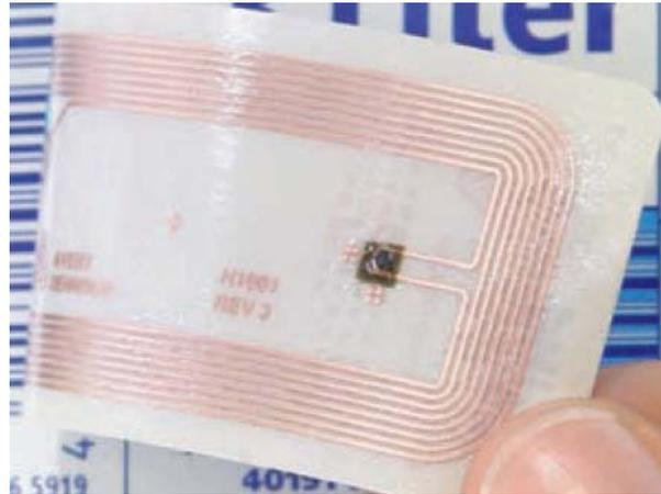
**Abbildung 8 – RFID Inlay mit Schleifenantennen**
