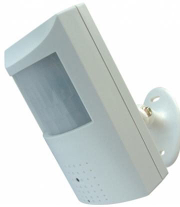
Abbildung 5: Eine als Alarmsensor getarnte, verdeckte Kamera
