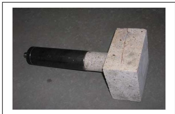
Abbildung 3-7: Oberer Druckstempel aus hochlegiertem Stahl
