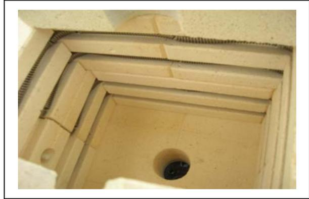
Abbildung 3-3: Innenraum des Ofens mit Heizspiralen und Temperaturmesser
