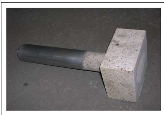
Abbildung 3-6: Unterer Druckstempel mit Aluminiumzylinder
