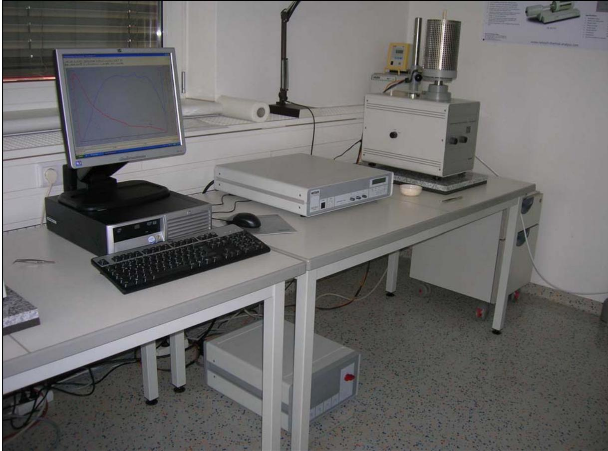
Abbildung 3-15: STA 409 EP von Netzsch
