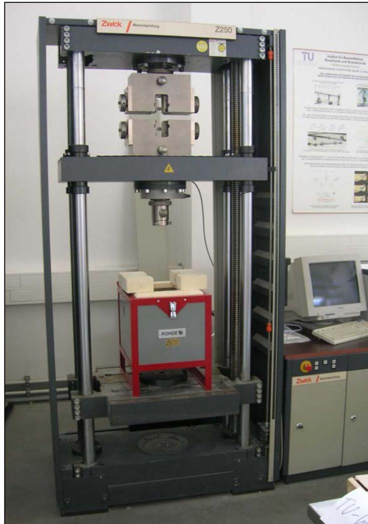
Abbildung 3-8: Universalprüfmaschine Zwick-Z250
