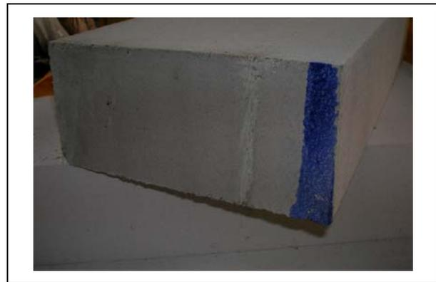
Abbildung 2-17: Porenbeton – Planstein:
