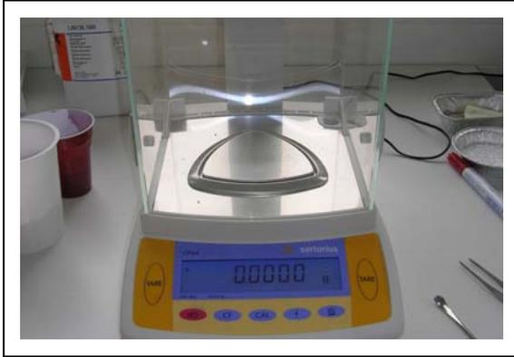
Abbildung 3-16: Sartorius Waage mit einer Messgenauigkeit von 1/1000 Gramm
