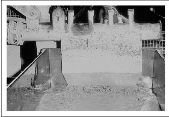
Abbildung 2-2: Einfüllen der Rohstoffmischung in die Form (BVB, /5/)
