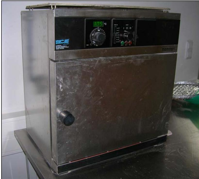
Abbildung 3-14: Trocknungsofen bei 105°C
