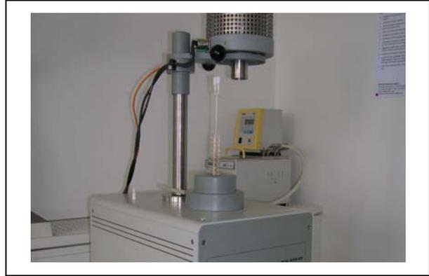
Abbildung 3-17: Probenhalterung mit Probetiegel und Referenzprobetiegel
