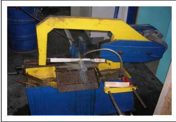
Abbildung 3-4: Herstellung des Aluminiumzylinders
