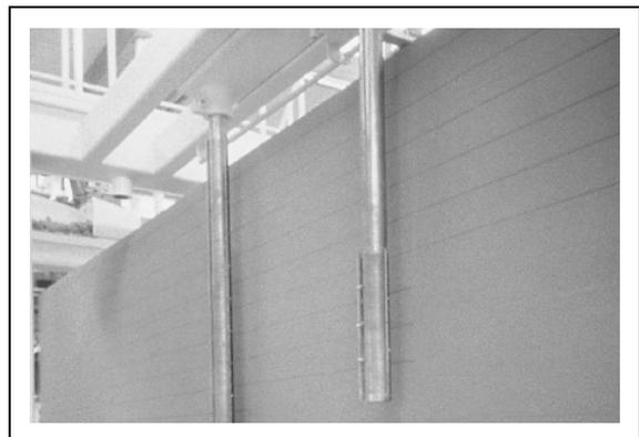
Abbildung 2-5: Schneiden des Rohblocks mittels straff gespannter Drähte (BVB, /5/)
