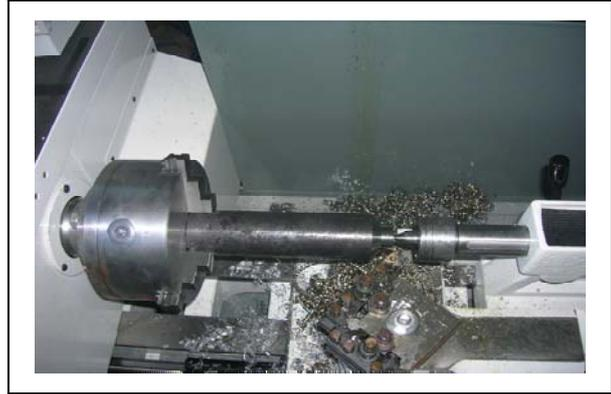
Abbildung 3-5: Drehen des Stahlzylinderkopfes auf der Drehbank
