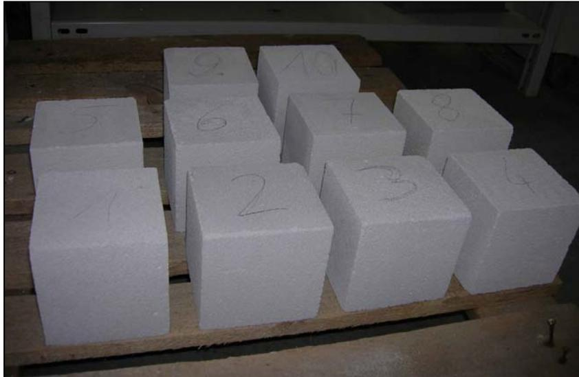
Abbildung 3-18: Durchnummerierte 100x100x100 mm Proben
