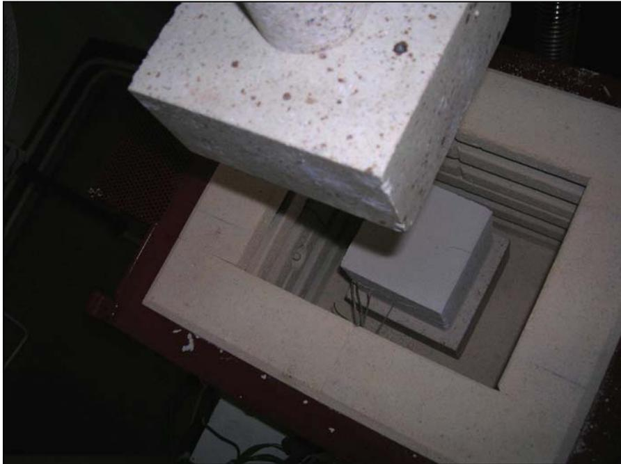
Abbildung 3-12: Probekörper mit installierten Thermoelementen
