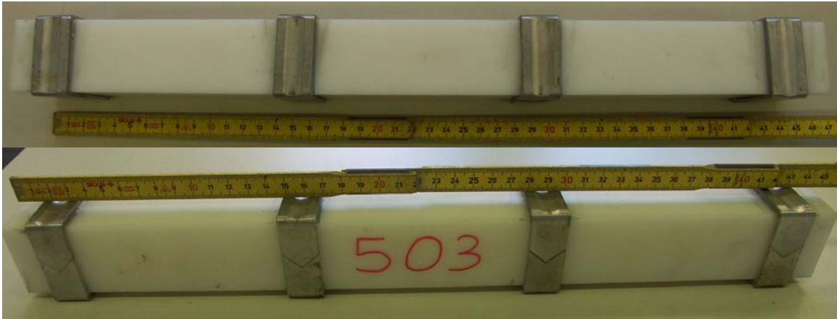
Abbildung 43: Kalibrierkörper Teflon für den Kalibrierversuch am 4-Punkt-Biegebalken
