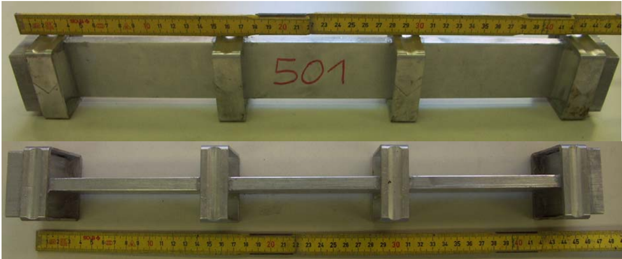
Abbildung 37: Kalibrierkörper für den 4 PBB, aus Aluminium
