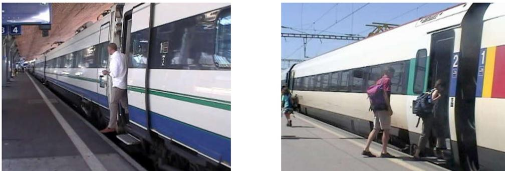
Abbildung 5.15: Aus- und einsteigende Fahrgäste lassen oft die Trittstufe aus, wenn diese auf selber Bahnsteighöhe liegt [19]
