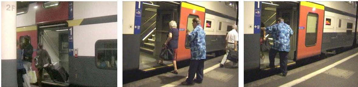
Abbildung 5.10: ein- und aussteigende Fahrgäste bei einem IC2000 an einer Bahnsteigkante von 38cm [19]
