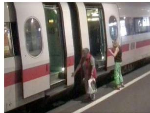
Abbildung 5.23: Die Fahrgäste benötigen oft Hilfe der anderen Reisenden ICE an einer Bahnsteigkante 38cm [19]
