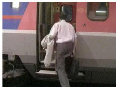
Abbildung 5.13: Fahrgäste bei ICEs und TGVs an einer Bahnsteigkante von 38cm [19]
