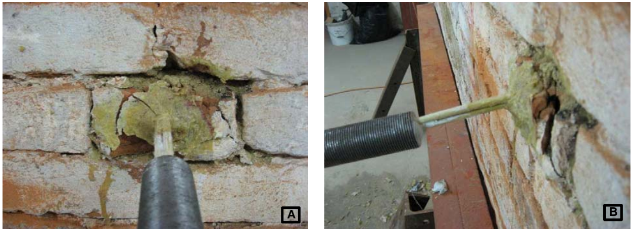
Abb. 5.35: Zwei Darstellungen der Versagensart des Ausziehversuches: Probe Nr. 1
