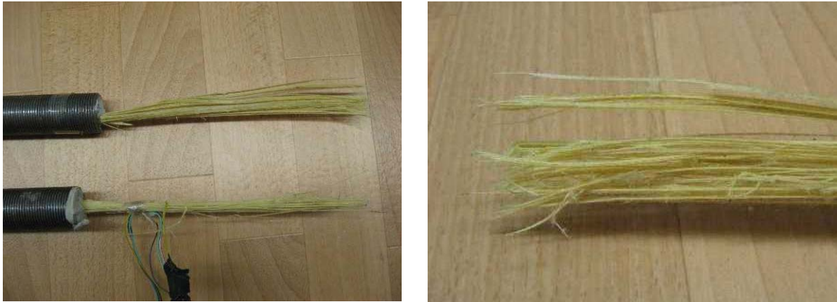
Abb. 5.16: Darstellungen des gerissenen Aramidstabes
