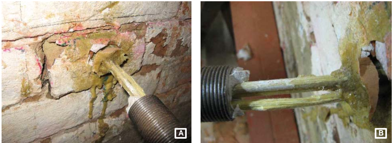
Abb. 5.37: Zwei Darstellungen der Versagensart des Ausziehversuches: Probe Nr. 2
