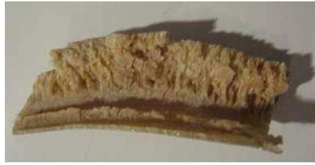
Abb. 5.29: Poröse Struktur des Injektionsharzes
