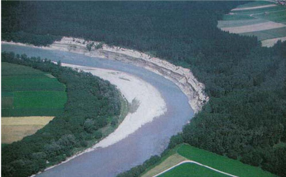
**Abb. 9.4. Typisch ausgeprägtes Kurvenprofil mit Erosion am Prall- und Anlandung am Gleithang bzw. Gleitufer [32], [38]**
