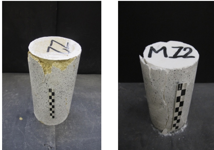
Abbildung 40: Marmor und Sandsteinzylinder nach Versuchsdurchführung
