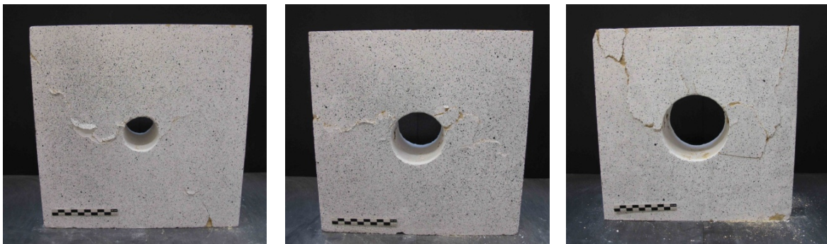
Abbildung 50: Rissbild bei Verwendung einer Aluminiumzwischenlage Links: Prüfkörper M2, Mitte: Prüfkörper M8, Rechts: Prüfkörper M12
