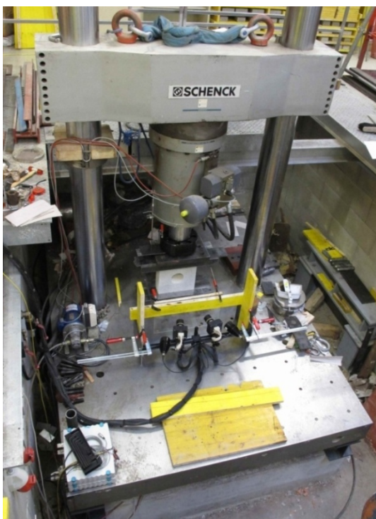
Abbildung 26: Versuchsaufbau der Versuchsreihe S bis L im Schenck Prüfrahmenn
