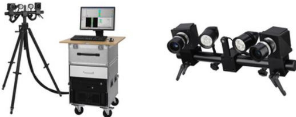
Abbildung 28: ARAMIS-Messsystem, Hochauflösende Kameras mit zugehörigem Hochleistungsrechner (GOM 2012)
