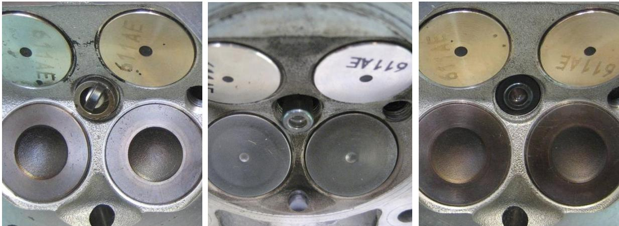
Abbildung 11-34: Gegenüberstellung der unterschiedlichen Einbaulagen im Brennraumdach von Zündkerze und Brennraumadapter (Variante 1 und 2)
