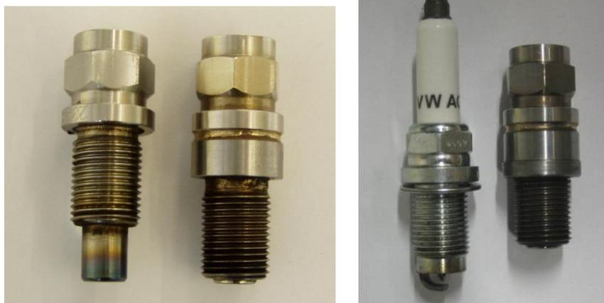
Abbildung 11-33: Gegenüberstellung der beiden untersuchten Brennumadapter und der Zündkerze
