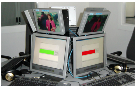
(a) Ein System mit dem mehrere Schnellschreiber zusammenarbeiten um mithilfe von QWERTZ Tastaturen Untertitel zu erstellen (b) Eine Stenografin bei der Arbeit mit einem Computerstenografiesystem
