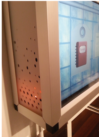
Abbildung 5.35: Einbohrungen für die Belüftung
