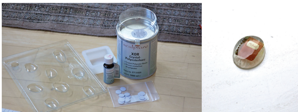
Abbildung 5.32: Eingießen der Tags in Gießharz
