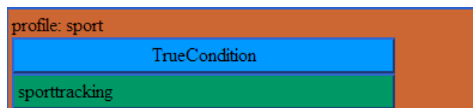
Abbildung 5.9: Deklaration eines manuellen Profils, das bei manueller Aktivierung den Event sportTracking ausführt, beispielsweise um sportliche Aktivität permanent zu erfassen.
