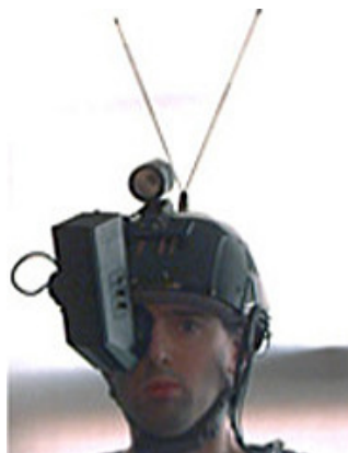
(a) Tragbares System bestehend aus Fernseher, Lampe und Antennen. (Quelle: [3])
