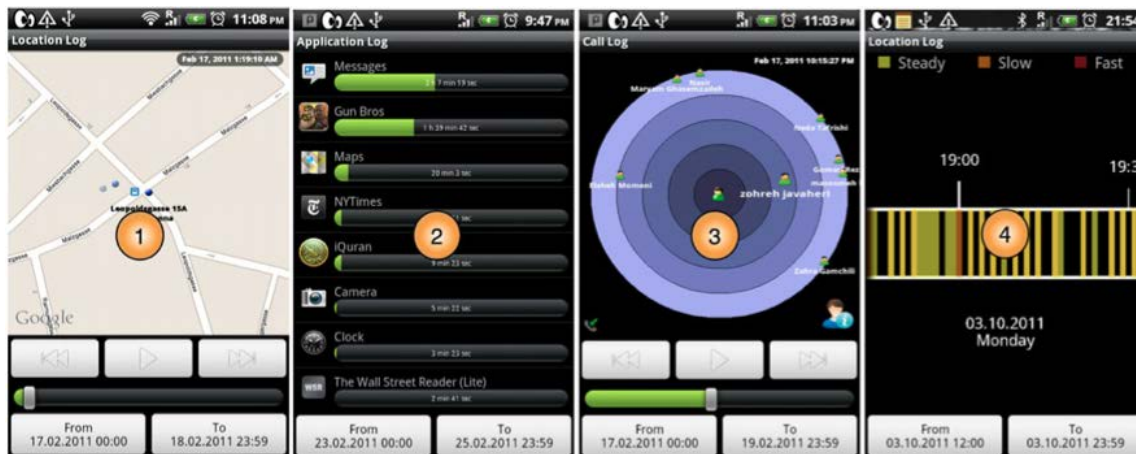
Abbildung 3.14: GUI von UbiqLog. 1: Standort; 2: History der aktiven Anwendungen; 3: Telefongespräche; 4: Abstrahierte Aufenthalts-Visualisierung. (Quelle: [96] S. 15)
