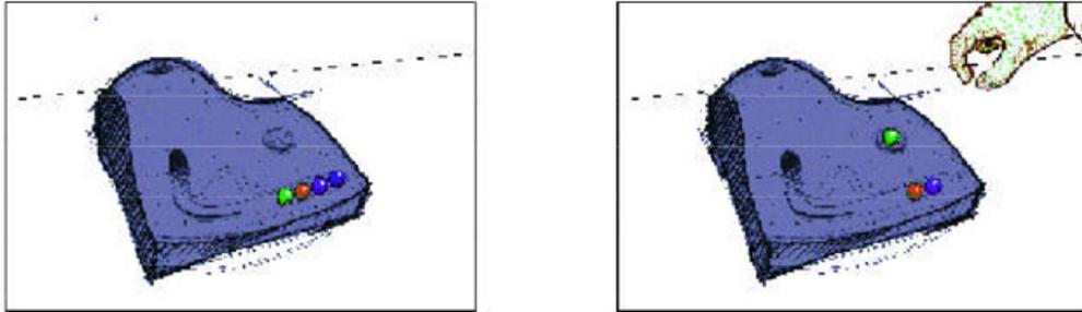
**Abbildung 2.1:** Jede Murmel visualisiert eine eingegangene Nachricht. Der User hört eine Nachricht ab, indem er die grüne Kugel in die Vertiefung legt [2].
