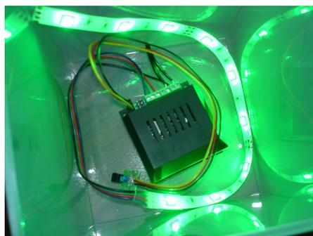
**Abbildung 5.35:** Plexiglaswürfel mit RGB-Controller
