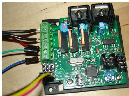
**Abbildung 5.30:** Anschlüsse des RGB-Controllers.
