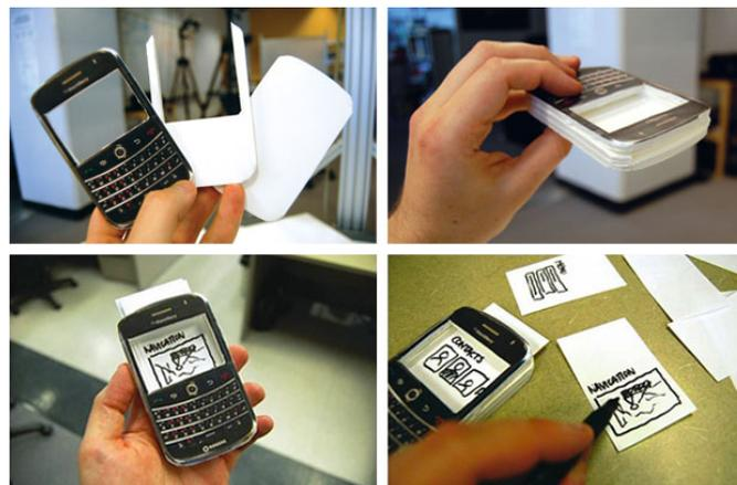
**Abbildung 4.5:** Mock Up eines Handys: Die Interaktion wird mit einem wechselbaren Papierdisplay demonstriert. [37]
