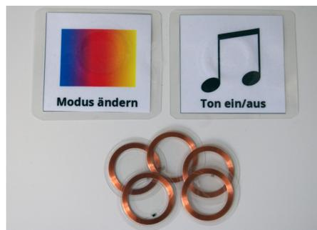
**Abbildung 6.5:** Greifbare Objekte zur Änderung des Darstellungsmodus, zum Ein- und Ausschalten des Signaltons und zum Anlegen von Benutzern am Ausgabegerät.
