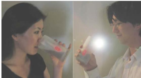
**Abbildung 5.1:** Während die Benutzerin im linken Bild den Becher mit den Lippen berührt, leuchtet der Becher des Benutzers im rechten Bild. Dieser sieht zudem den Füllstand des Bechers der Benutzerin [25].
