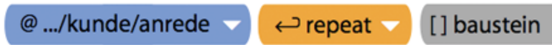
Abbildung 5.3: Das Aussehen von dynamischen (blau) und logischen (orange) Elementen. Das graue Element stellt ein Subtemplate dar: ein Dokumentteil, der einmal definiert und beliebig oft referenziert werden kann.
