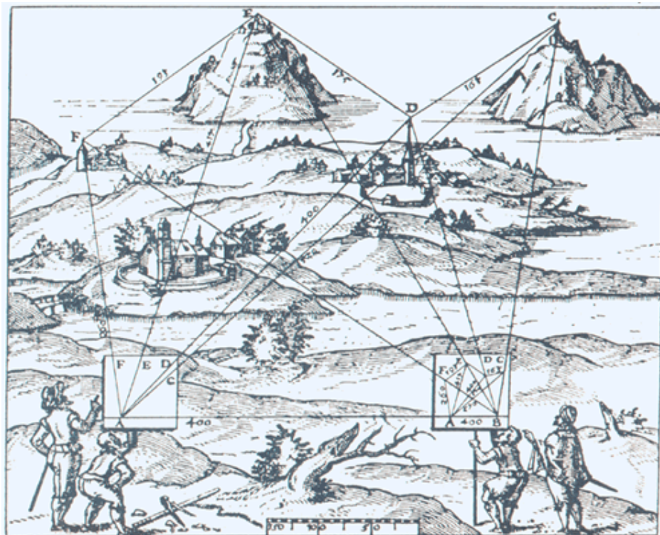
Abbildung 2.3: Geländeaufnahme mit dem Messtisch mittels Schnittmethode
