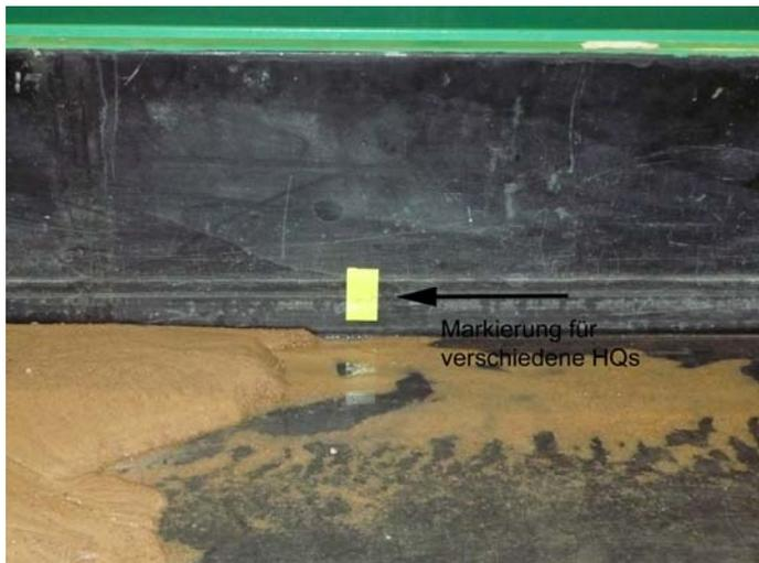
**Foto 6.45: Markierung auf welche das Unterwasser eingestellt wird.**
