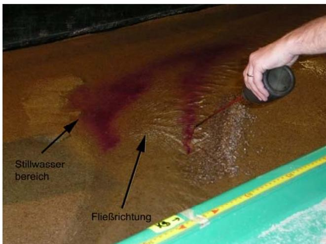
**Foto 6.64: 2. Versuch. HQ30. Stillwasserbereich und Strömungsverlauf.**
