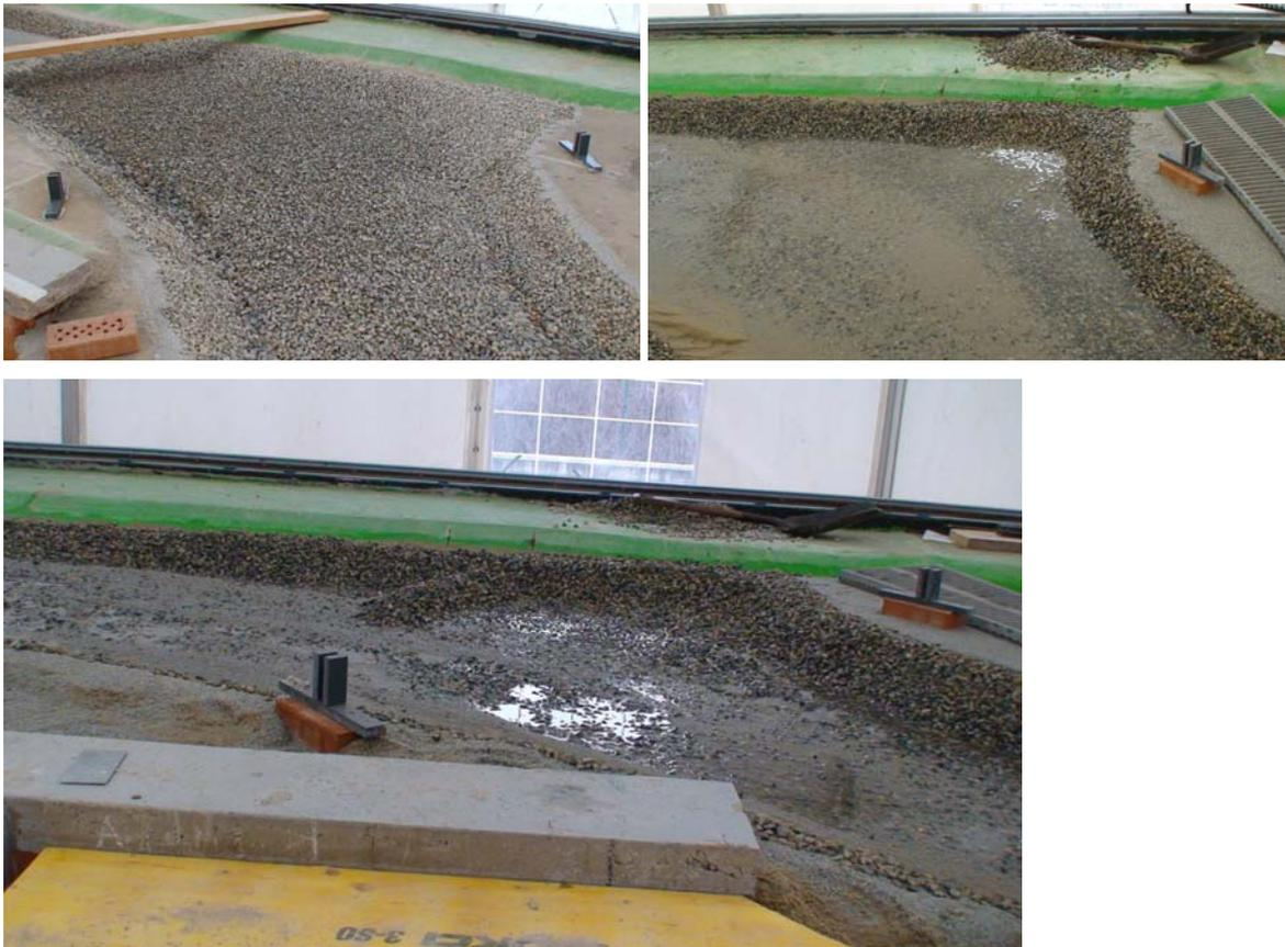
**Foto 6.134: Vollmodell. Varianten: Ausrundung, direkte Anströmung und Buhne. [2]**
