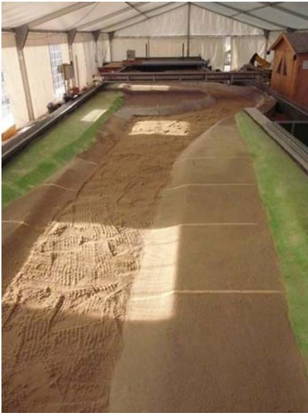
**Foto 6.110: Endgültige Sandschicht wird aufgebracht.**
