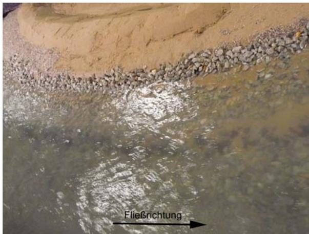
Foto 6.86: 2. Versuch. Teilschnittmodell. HQ30/2 und Neigung 1,0‰. Böschung.
