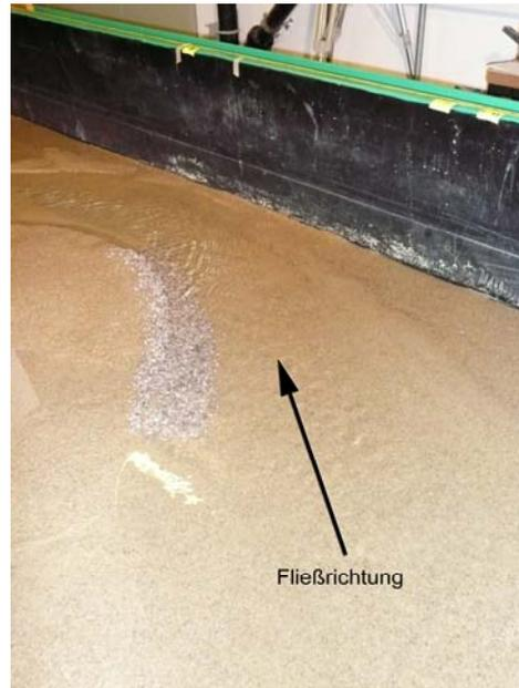
**Foto 6.18: 2. Versuch. Detail Böschungssicherung bei HQ100.**
