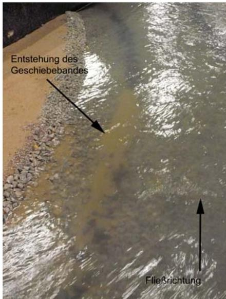
**Foto 6.85: 2. Versuch. Teilschnittmodell. HQ30/2 und Neigung 0,8‰. Auslauf BU. Entstehung des Geschiebebandes.**
