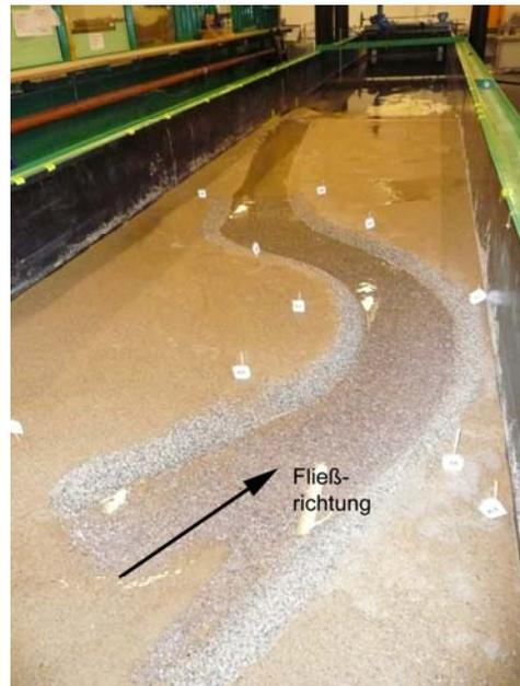
**Foto 6.49: 4. Versuch. Nachher. Baumleitung und Auslauf.**
