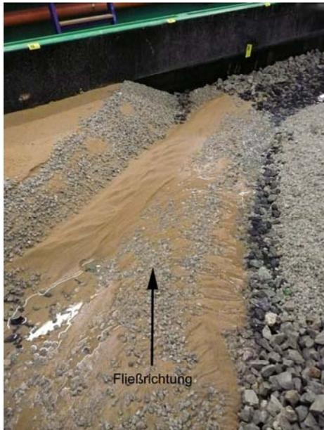
**Foto 6.105: 3. Versuch. Teilschnittmodell. Nachher. Auslauf BU mit Geschiebeband aus erodierter Sohle.**
