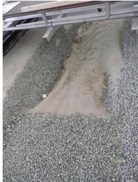
**Foto 6.132: 1. Versuch. Vollmodell. Kolkbildung im Auslaufbereich.**
