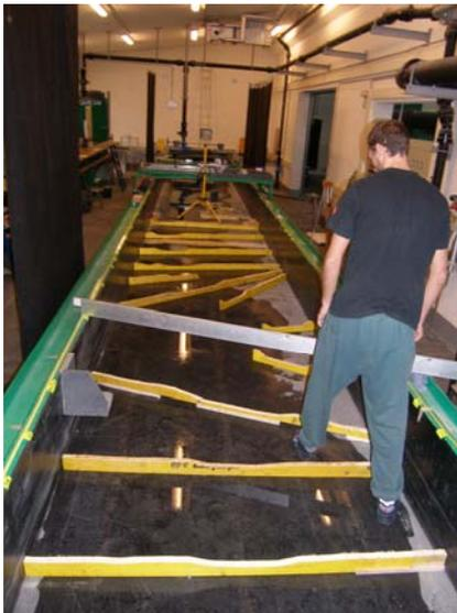
**Foto 6.1: Aufbau des Modells für den 1. Versuch. Auflegen und Ausrichten der vorbereiteten Profile in der Flußbaurinne. [1]**
