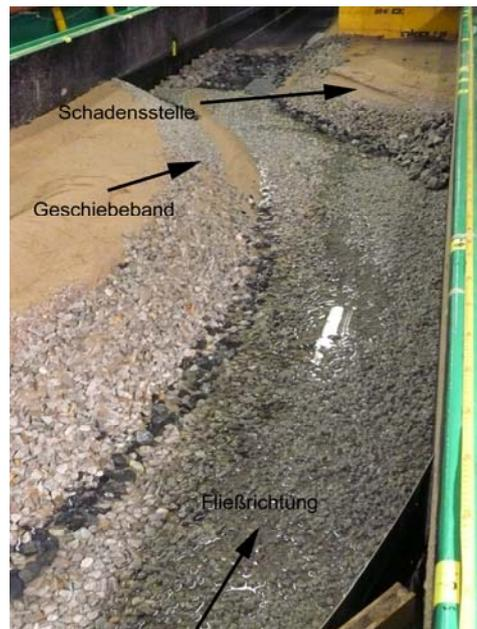
**Foto 6.81: 2. Versuch. Teilschnittmodell. Nachher. Auslauf BU mit Geschiebeband und Schadensstelle.**
