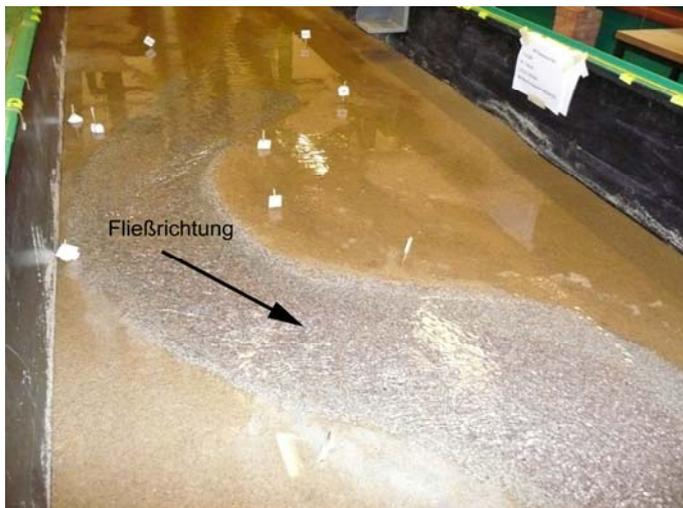
**Foto 6.60: 4. Versuch. Detail Baumleitung bei HQ100.**
