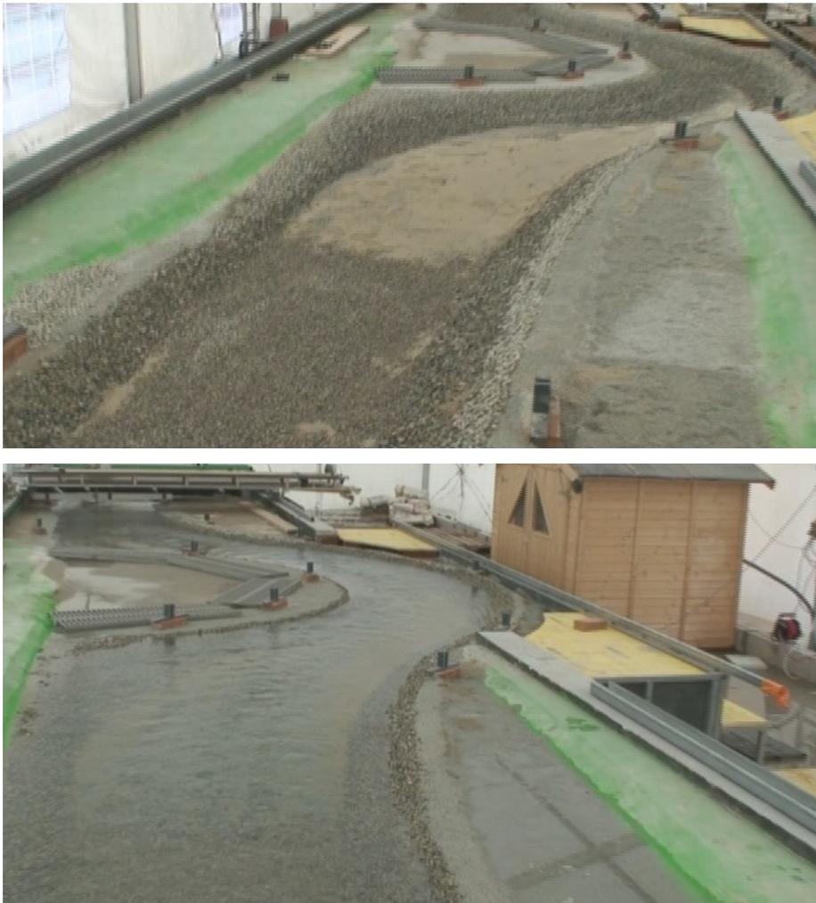
**Foto 6.133: Vollmodell. Dammerhöhung bei HQ100. [2]**
