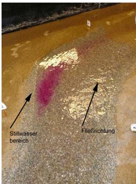
**Foto 6.65: 4. Versuch. HQ30. UW mit Markierung. Stillwasserbereich.**
