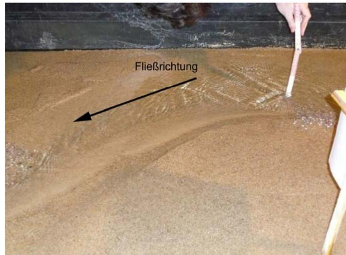
**Foto 6.22: 2. Versuch. Detail Geschiebeband bei HQ1000.**
