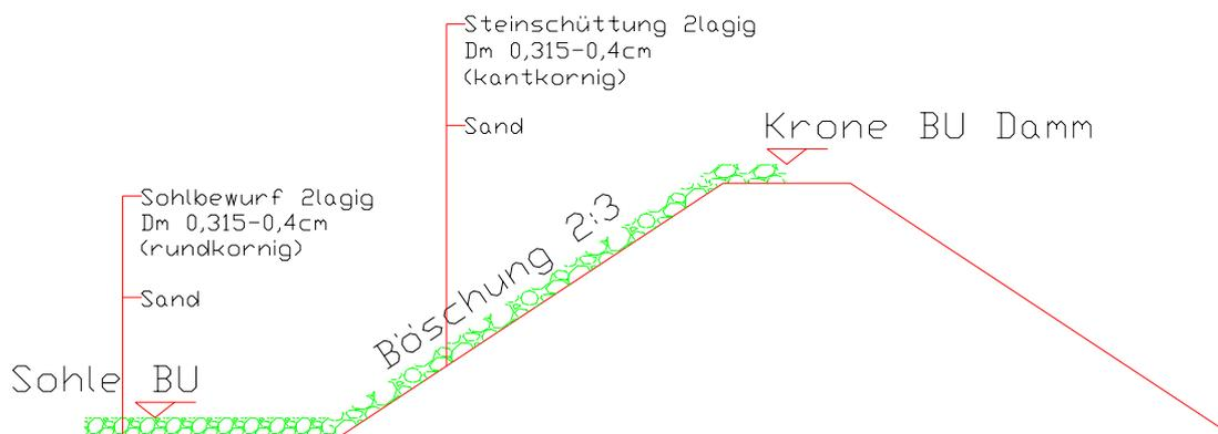
**Abb. 6.8: 3. Versuch. Schnitt durch Damm und Sohle der BU.**
