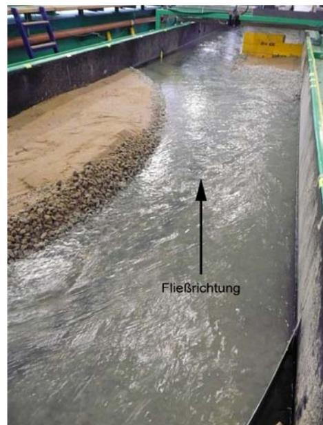
Foto 6.98: 3. Versuch. Teilschnittmodell. Neigung 2,0‰ und 56,8l/s. Auslauf BU.
