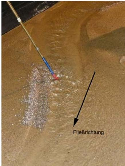
**Foto 6.21: 2. Versuch. Detail Böschungssicherung bei HQ1000.**
