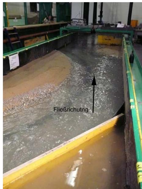
**Foto 6.84: 2. Versuch. Teilschnittmodell. HQ30/2 und Neigung 0,0‰. Auslauf BU.**
