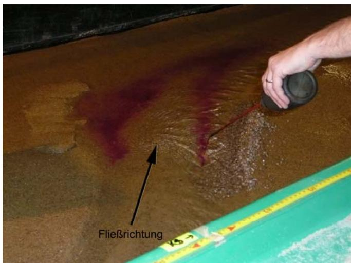
**Foto 6.16: 2. Versuch. Detail Böschungssicherung. Strömungsverlauf bei HQ30.**
