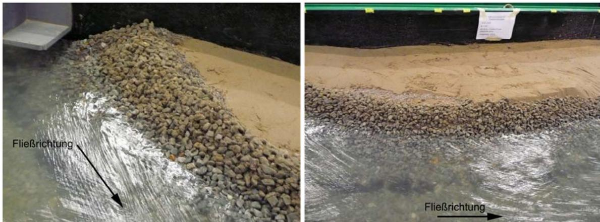
Foto 6.96: 3. Versuch. Teilschnittmodell. Neigung 2,0‰ und HQ30/2. Böschung mit 3 verschiedenen Filterschichten.
