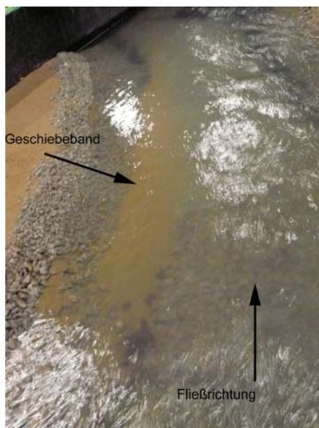
**Foto 6.92: 2. Versuch. Teilschnittmodell. HQ30/2 und Neigung 2,0‰. Auslauf BU mit Geschiebeband.**
