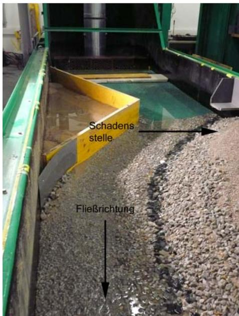
**Foto 6.80: 2. Versuch. Teilschnittmodell. Nachher. Einlauf BU mit Schadensstelle.**
