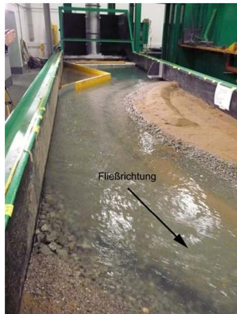
Foto 6.89: 2. Versuch. Teilschnittmodell. HQ30/2 und Neigung 1,6‰. BU.
