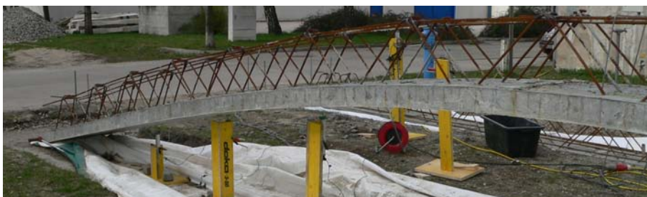
(b) System 2: Stahlbetonquerschnitt mit angeschweißter Bewehrung
