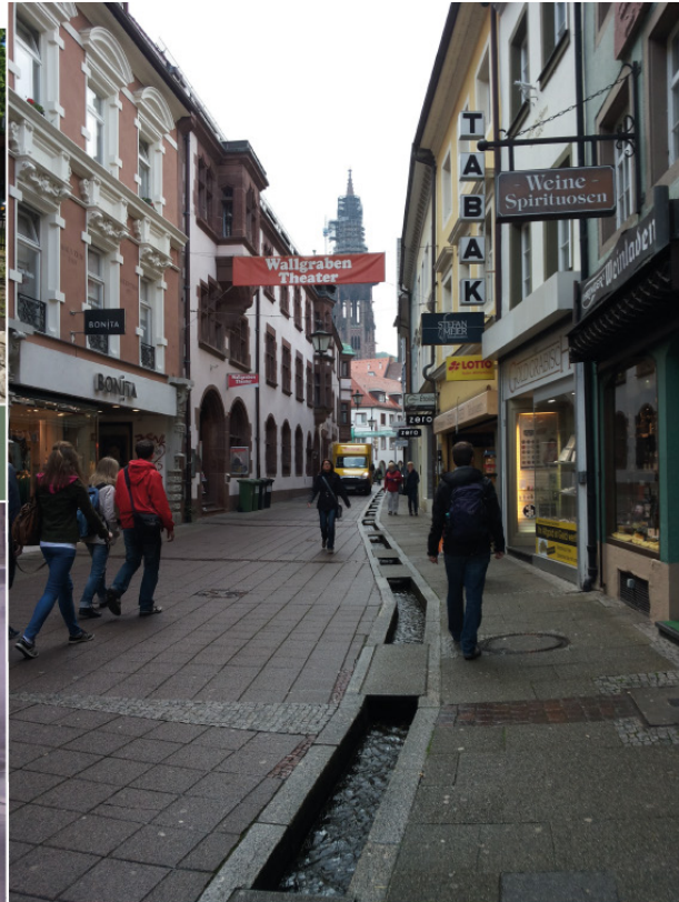
Freiburg - Deutschland Das Gefälle ermöglicht eine offene Wasserrinne
