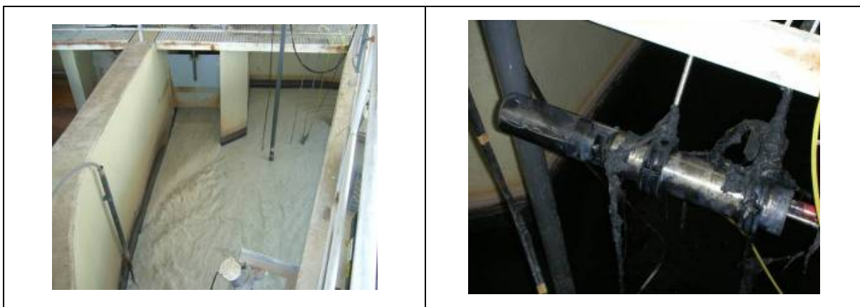
Abbildung 16: Messstelle Rundsandfang (links) und in-situ UV-Spektrometer (rechts) beim AWV Seewinkel
