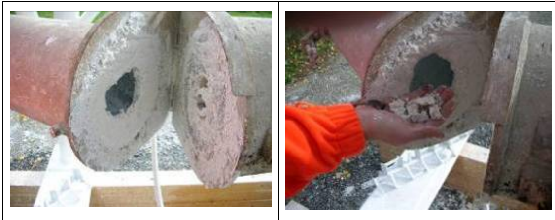
Abbildung 45: Verstopfung der Kalkmilch Dosiereinheit beim AWV Seewinkel
