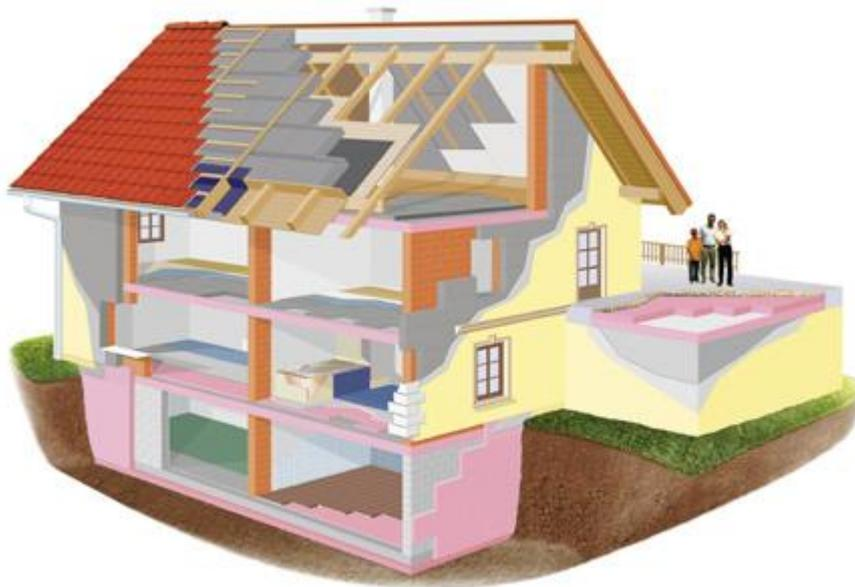
Abb. 5.1. Anwendungen der Dämmstoffe
