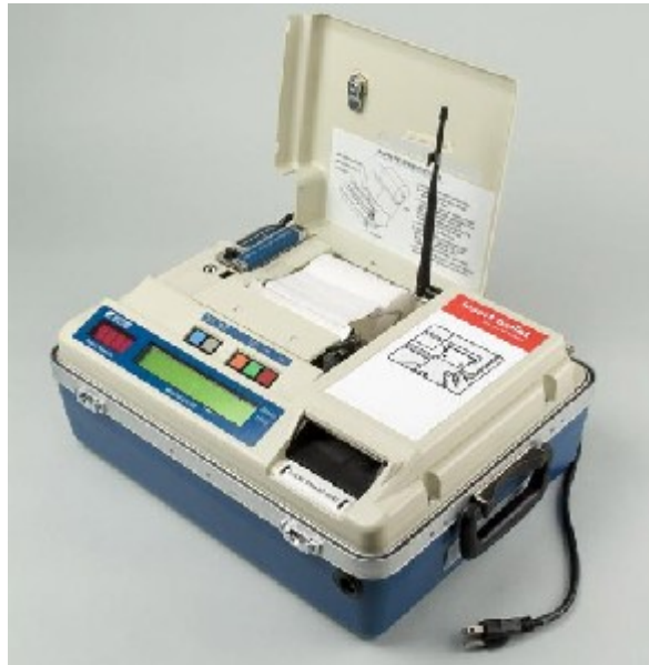
Abbildung 7: Optischer Scanner für Lochkarten. Quelle http://americanhistory.si.edu/vote
