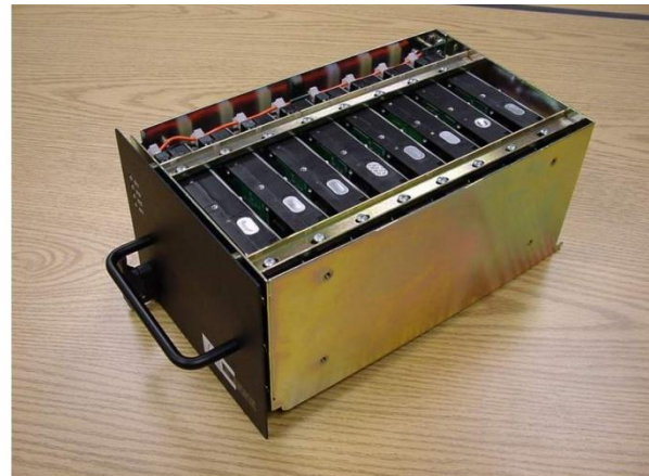
Abb. 2-4: Mark V Prototypgehäuse und „8-pack“ Modul ( http://web.haystack.mit.edu/mark5/ ).
