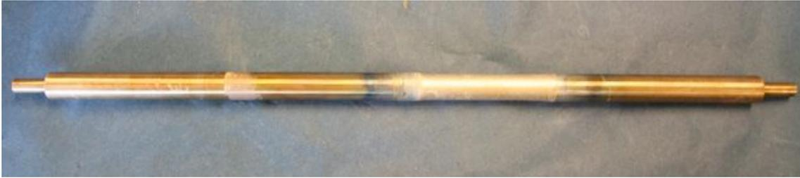
Abbildung 3.6: Target nach dem Einsatz im Reaktor. Auffallend ist die veränderte Struktur und Farbe des abgesputterten Bereichs.
