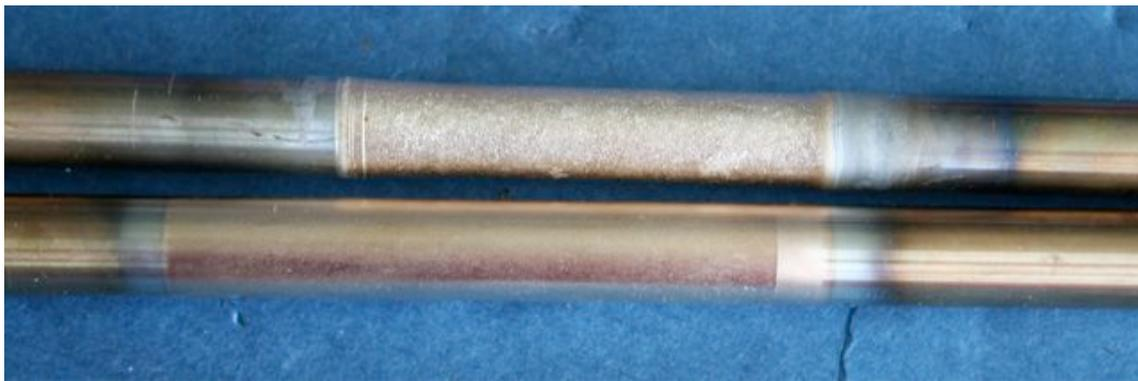
Abbildung 4.24: Zwei Targets nach Gebrauch. Das untere wurde vor Installation des Molybdänröhrchens verwendet, während das zweite während der Hälfte der Beschichtungsversuche eingebaut war. Gut sichtbar ist hierbei der Abtrag durch den Sputterprozess sowie oxidische Verfärbungen an den Enden.
