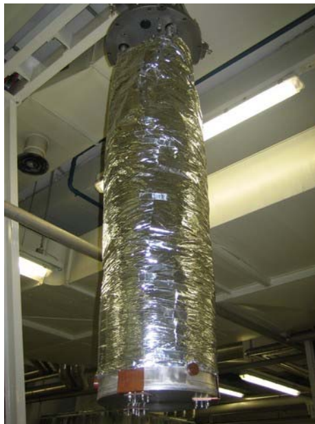
Abb. 3-17 Mit Superisolation umwickelter Messaufbau
