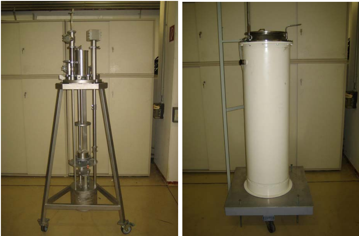
Abb. 3-9 Versuchsaufbau ohne Verkabelung auf Dreibein (links); Plattform für den Kryostaten (rechts)
