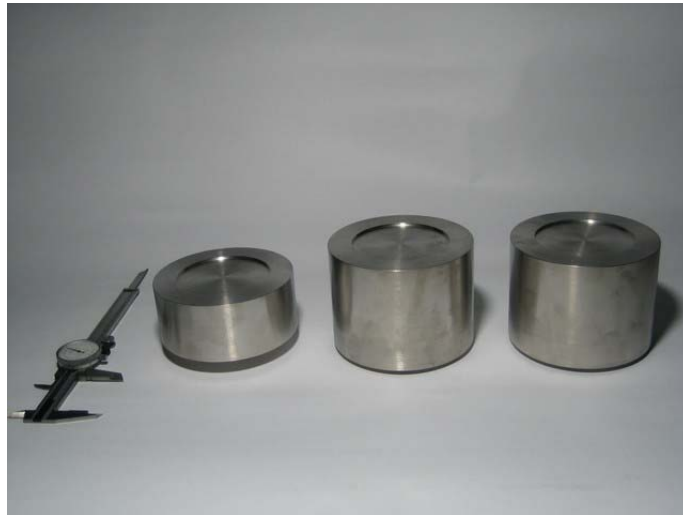
Abb. 3-10 Massen zum Aufbringen der Auflagekraft
