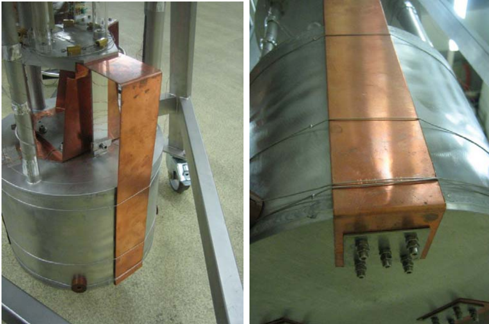
Abb. 3-15 Kupferbleche zur Vergrößerung der Kühlleistung (im Aufbau sind auch bereits die Distanzstücke aus Vespel zu sehen)
