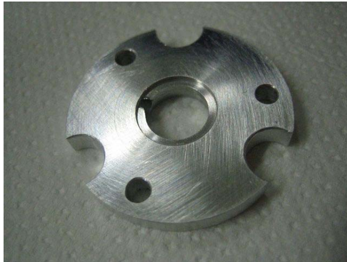
Abb. 4-3 neue Halterung ohne Strahlungsschild für obere Gegenfläche
