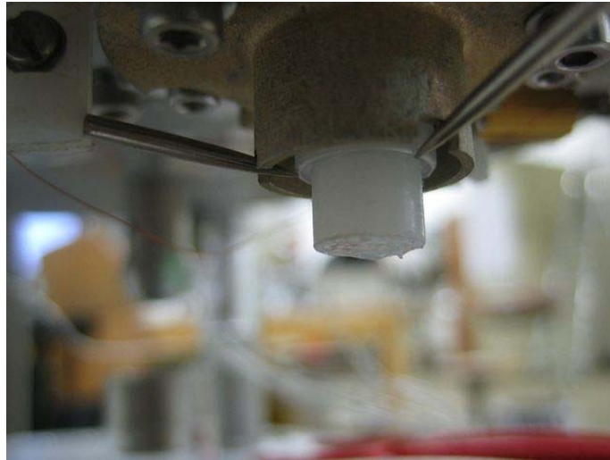
Abb. 3-27 HDPE-Probe in der Nadelhalterung (abgehoben)
