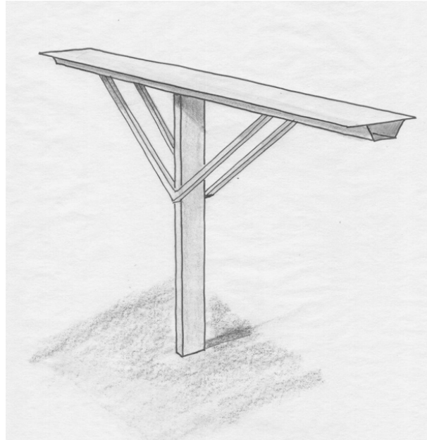
Abb.: 3-13 - System mit zwei außengeführten Druckstreben
