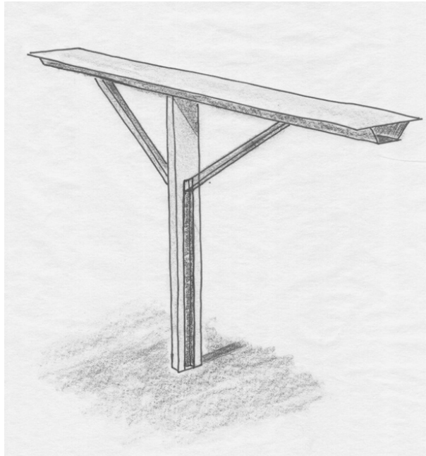
Abb.: 3-11 - System mit einer Druckstrebe und Pfeilermut
