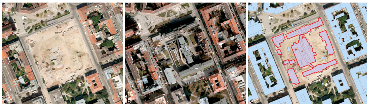
Abb. 2 Ermittlung des abgebrochenen Gebäudevolumens nach Gebäudekategorie basierend auf den Aufzeichnungen über Abbruchanzeigen in Wien, a Orthofoto (2013), b Orthofoto (2012) und c der digitalen Stadtkarte (2012)
