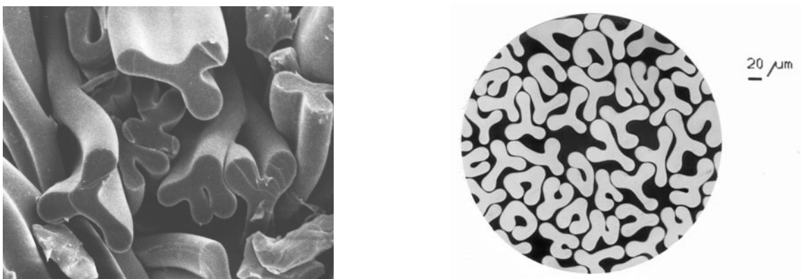
Abbildung 7-3: Querschnittsformen multilobaler Polyimid-Fasern
