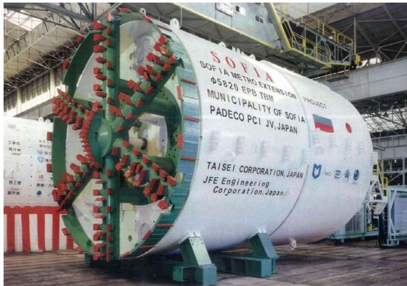
**Abb. 55: Der Erddruckschild, U-Bahn Sofia, I Durchquerung [1.39]**
