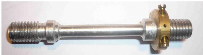
Abbildung 2.22.: Kriechprobe mit einem Messring zur Befestigung der Thermoelemente
