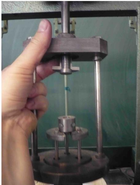
Abbildung 3.33.: Einführung der Zugvorrichtung
