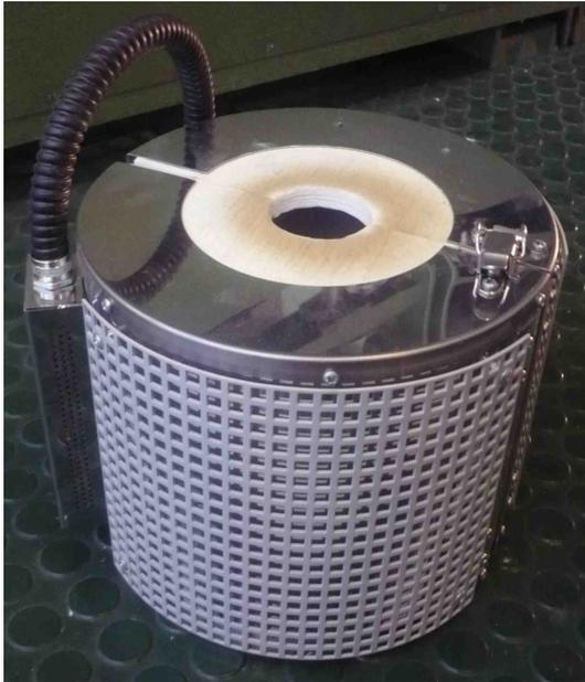
Abbildung 3.1.: Klappprohrofen
