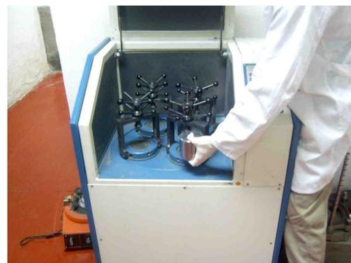
Abbildung 2.26.: Kugelmühlverfahren mit 4 Behälter [8]
