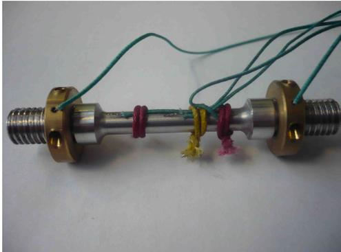
Abbildung 2.23.: Probe mit 5 Thermoelementen bestückt
