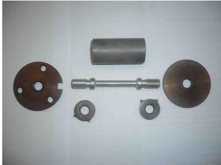
Abbildung 3.23.: Einzelteile der mittleren Baugruppe
