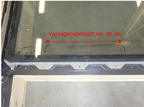
**Abbildung 51: Ablösung des Acrylatklebstoffs im Eckbereich**
