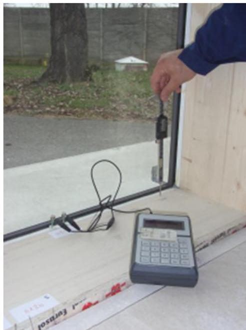
**Abbildung 62: Messung des Scheibenabsetzverhaltens sowie der Holzfeuchtigkeit**
