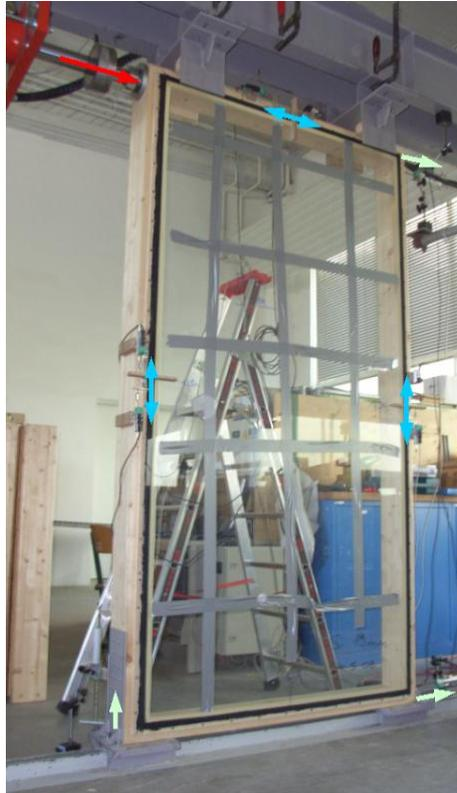
**Abbildung 69: Großelementuntersuchung; Messanordnung**
