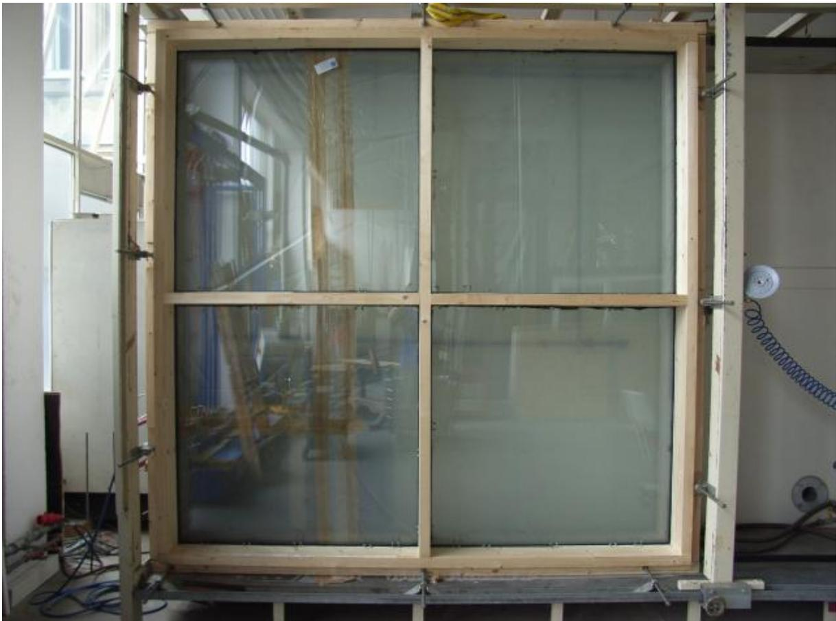
Abbildung 46: Fassadenprototyp 2 im Fensterprüfstand
