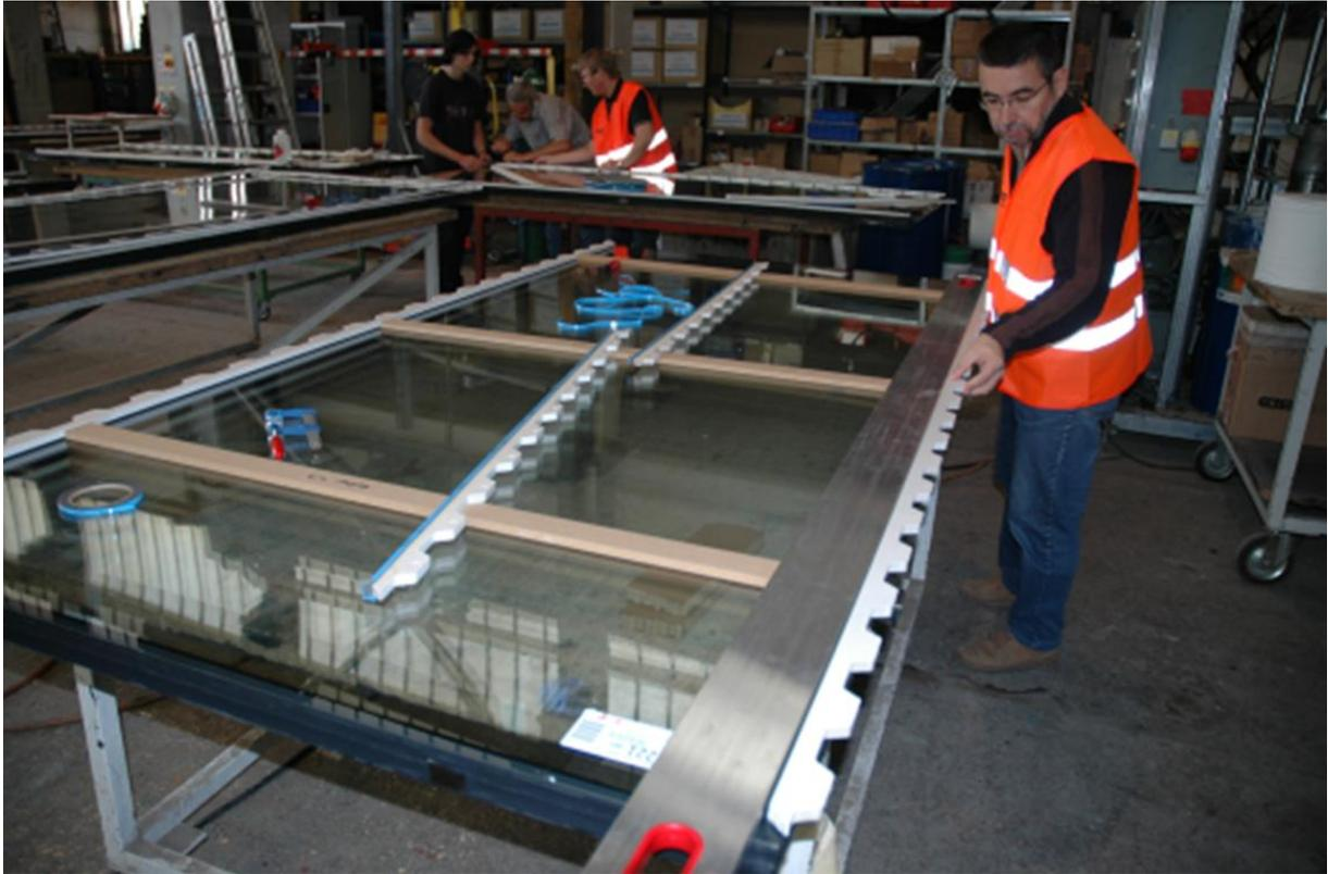
**Abbildung 105: Anbringen der Koppelleiste an der Glaskante**
