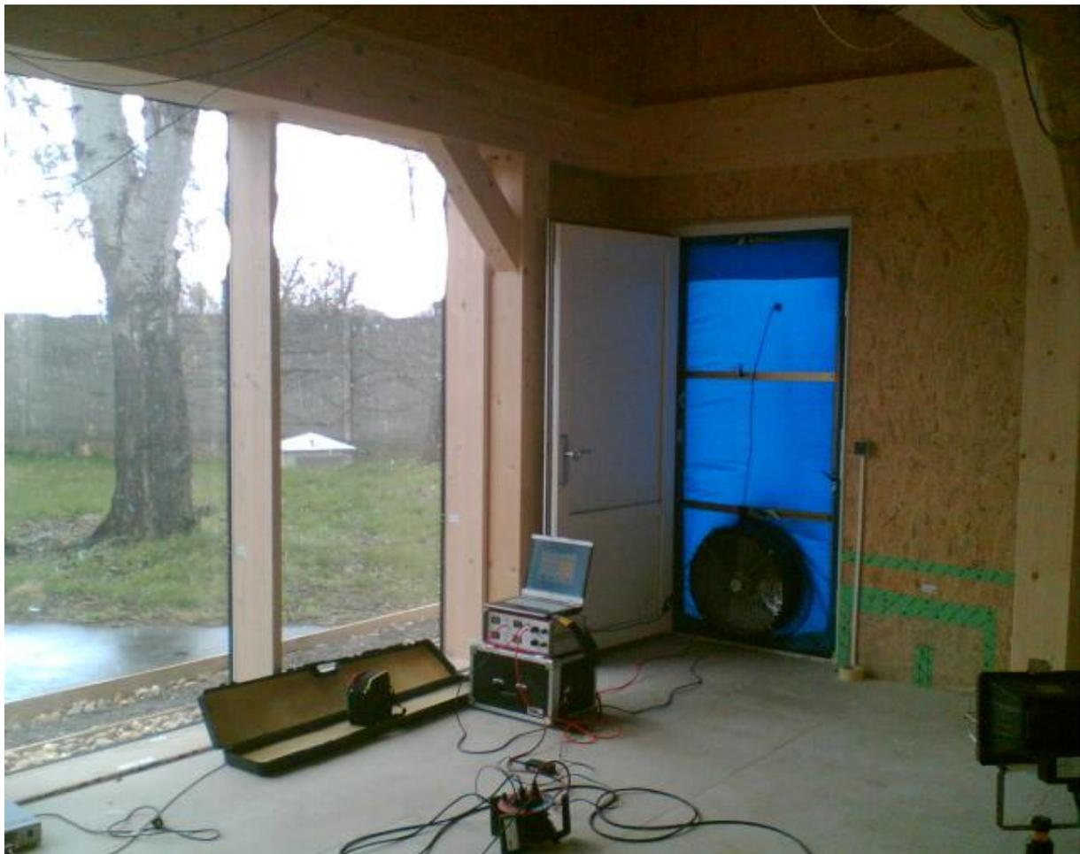
**Abbildung 60: Blower Door Messung im Versuchsgebäude**
