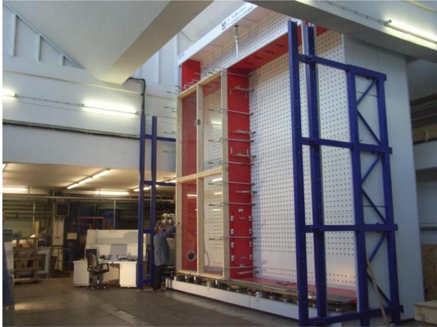
**Abbildung 57: Zweigeschoßiger Prototyp im Fassadenprüfstand**
