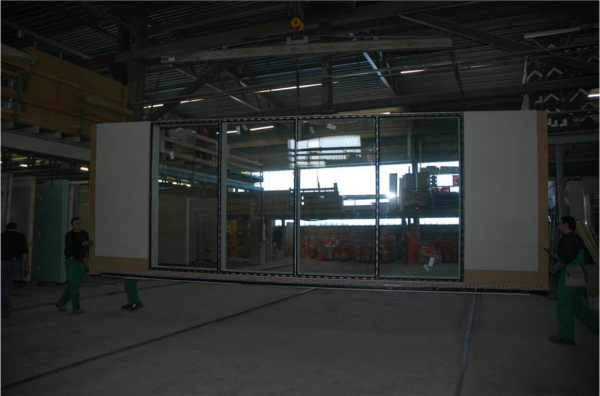
**Abbildung 97: Umheben der fertig montierten Elementfassade**
