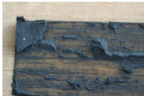
**Abbildung 22: Bruchbild nach der Wasserlagerung**
