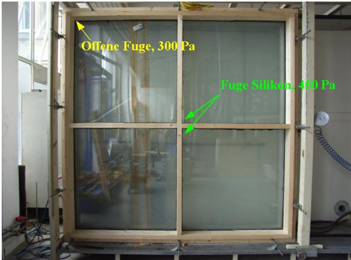
Abbildung 47: Lokale Undichtheitsstellen unter Schlagregenbeanspruchung
