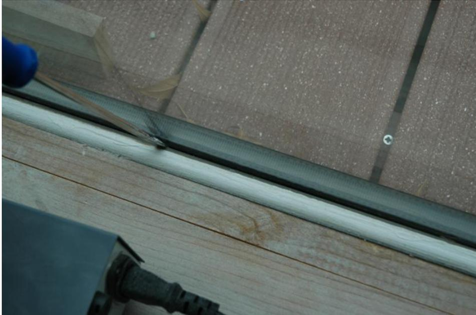
**Abbildung 63: Kohäsives Versagen des Acrylatklebstoffes zwischen Glas und Klebstoffsubstrat**
