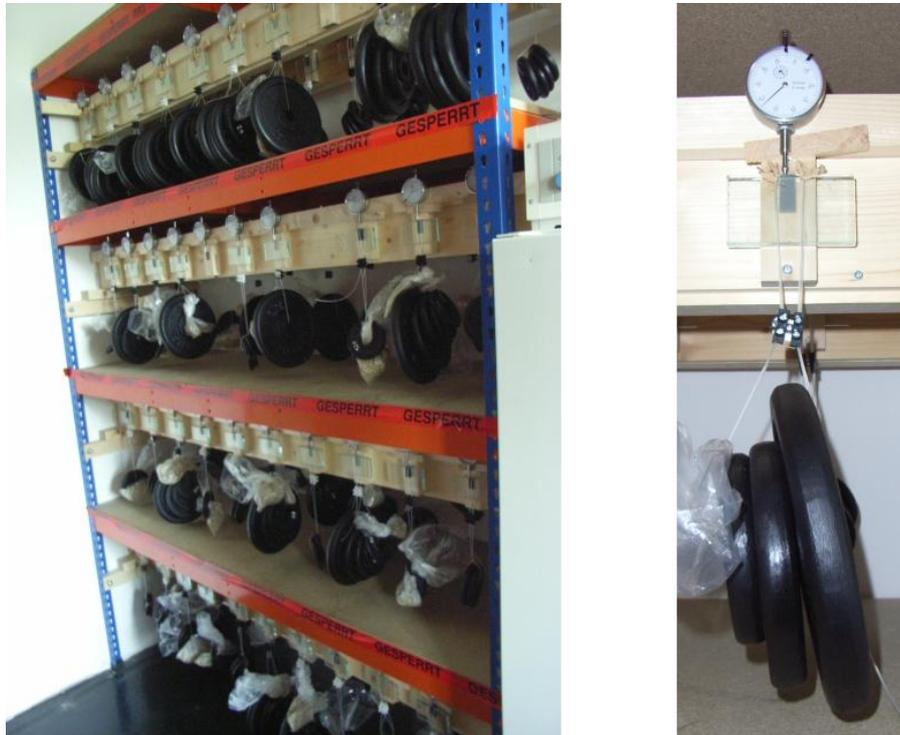
**Abbildung 19: Kriechuntersuchungen am Kleinprüfkörper**
