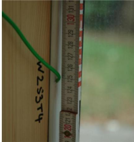
**Abbildung 61: Messung der Temperatur nahe der Klebstoffuge**
