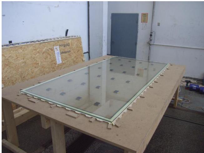
**Abbildung 65: Einheben der Glasscheibe auf den Richrahmen**
