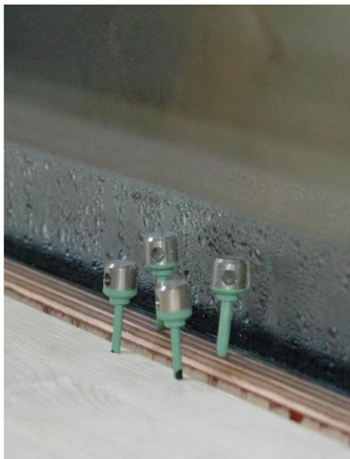
**Abbildung 28 – Oberflächenkondensat am Glasrandverbund ca. 40 mm breit**
