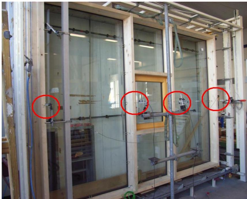
**Abbildung 27 – Messung der Durchbiegung unter Winddruck und –sog an 4 Messstellen**
