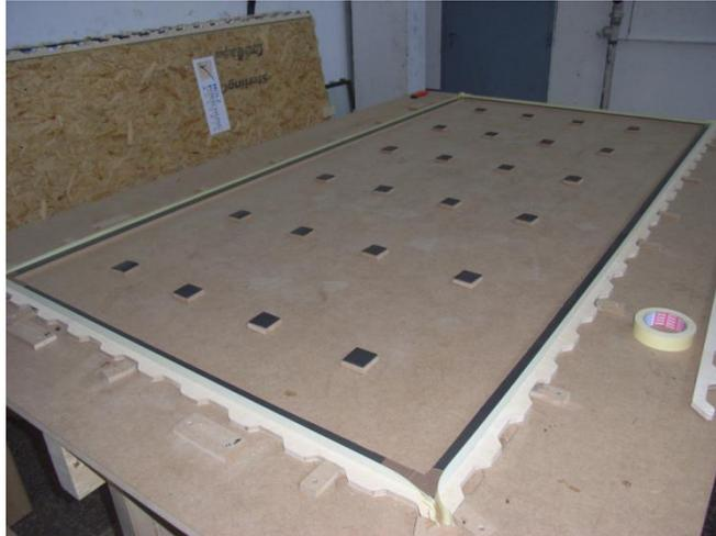
**Abbildung 64: Einklemmen der Koppelleiste in den Richrahmen**
