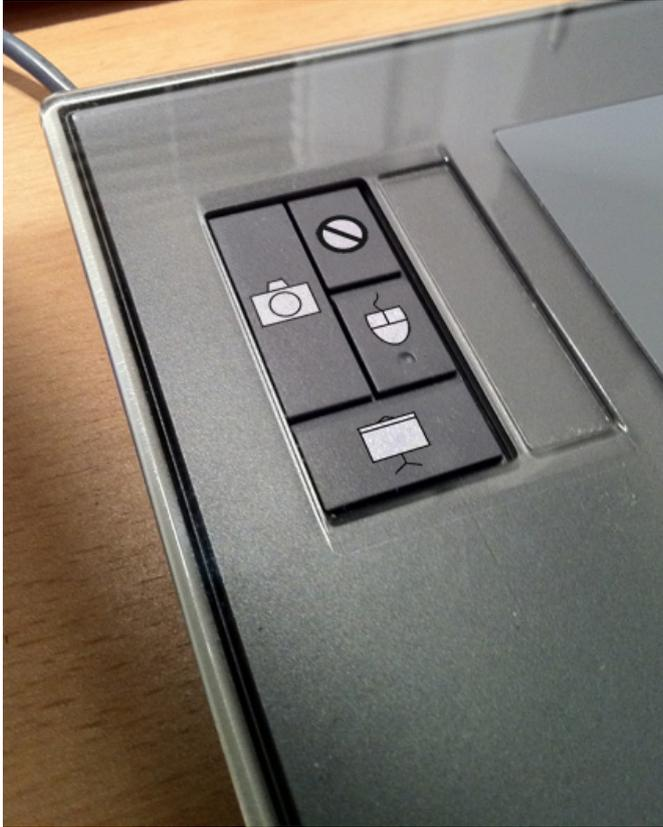
Abbildung 6.7: Die Anordnung der *Scribbler* Funktionen auf den Tasten des Tablets. Der Fotoapparat links oben erstellt ein Bildschirmfoto, das Verbotssymbol auf der rechten, oberen Taste löscht alle Zeichnungen des aktiven Fensters, die Maus auf der genoppten, mittleren Taste wechselt den Interaktionsmodus und das Whiteboard auf der unteren Taste blendet selbiges ein oder aus.
