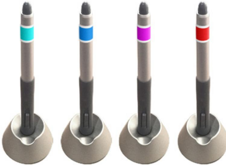
Abbildung 6.8: Jeder Stift ist eindeutig vom System identifizierbar und hat eine eigene Farbe zugeordnet. Zur Verdeutlichung, wurde jedem Stift ein entsprechend gefärbter Sticker aufgeklebt.
