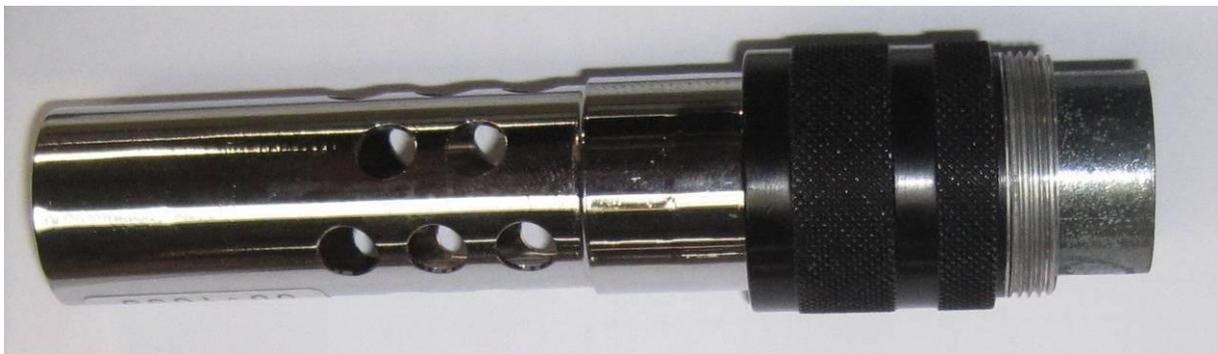
Abbildung 2.13: Temperaturmessfühler (Pt-100) mit installiertem Strahlungsschutz.
