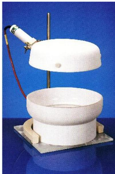
Abbildung 4.3: Oberflächenverdampfer der Fa. Quarzglas<sup>81</sup>.
