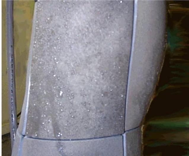
Abbildung 4.24: Thermal Manikin ADAM bei latenter Feuchteabgabe<sup>101</sup>
