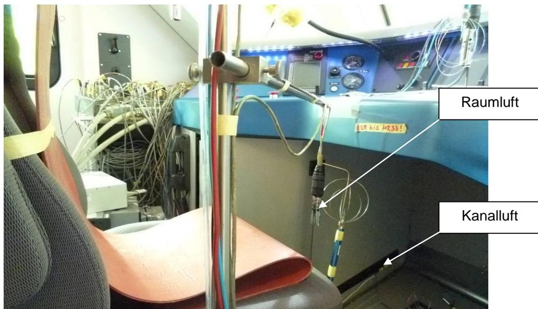
Abbildung 2.5: Beispielhafter Messaufbau für einen Fahrerstand (1).
