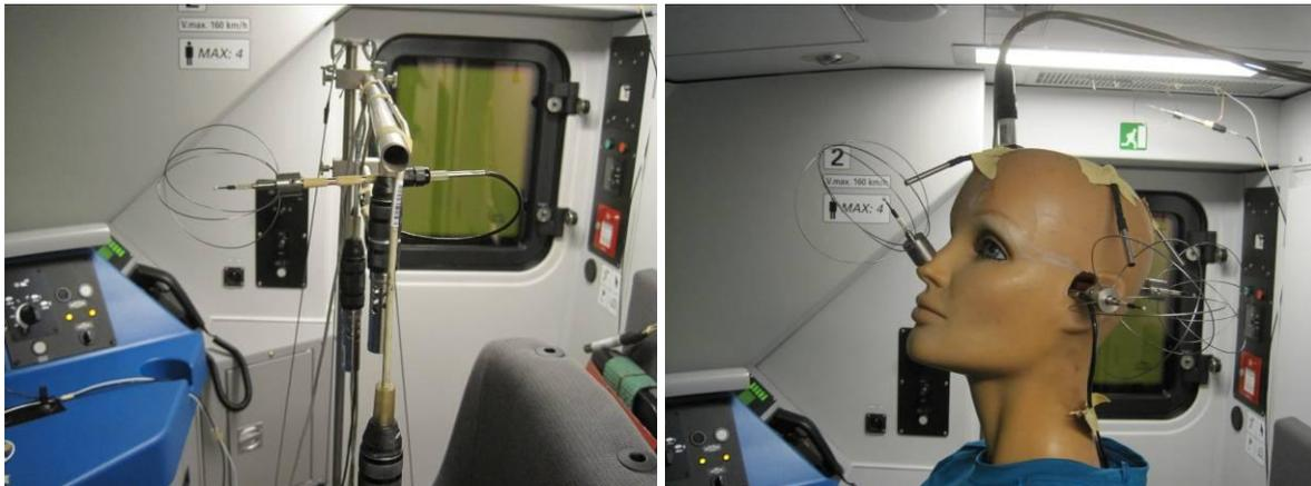
Abbildung 4.13: Messaufbau zur Evaluierung der Strömung im Kopfbereich.
