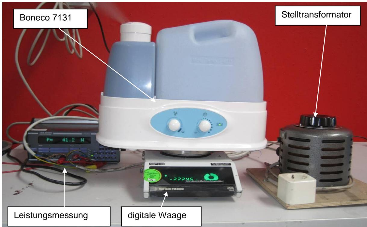
Abbildung 6.3: Versuchsaufbau zur Kalibrierung des Boneco 7131.
