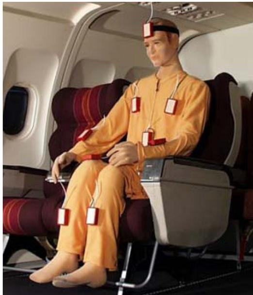
Abbildung 4.25: Behaglichkeitsmesssystem DRESSMAN<sup>102</sup>
