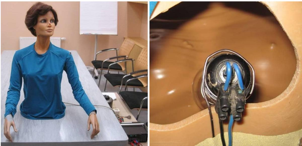
Abbildung 6.2: Messaufbau zu Erwärmungsversuchen einer Schaufensterpuppe aus PE.
