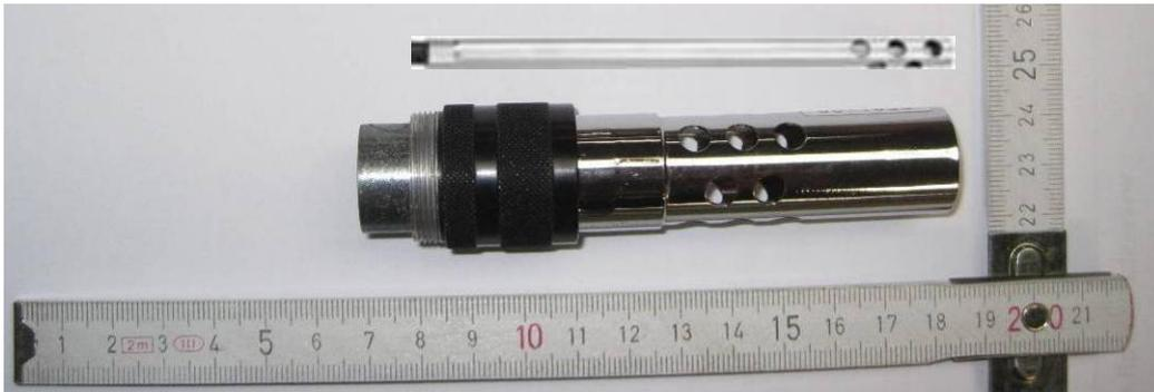
Abbildung 4.18: Größenvergleich zweier Pt-100-Messfühler.
