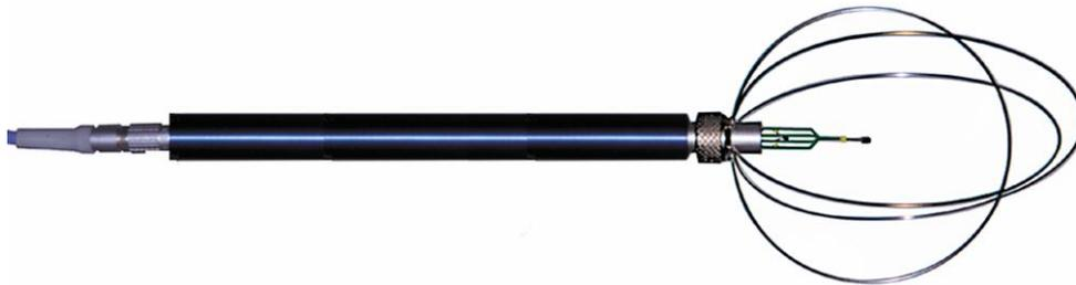
Abbildung 2.14: Hitzkugelanemometer der Fa. Schiltknecht.
