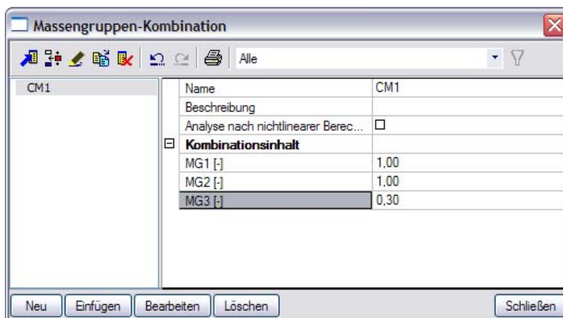
Abbildung 3.10: Definition der Massengruppen-Kombination in Scia-Engineer
