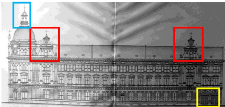
Abbildung 125 Ansicht des Postgebäudes in Krakau [gelb: Ein- und Ausfahrt sind von einander getrennt; die zwei Tore liegen nebeneinander/ rot: Eckrisalit Aufsätze sind aufwendig gestaltet/ blau: Kuppel der Rotunde wird noch einmal von einem Türmchen bekrönt]
