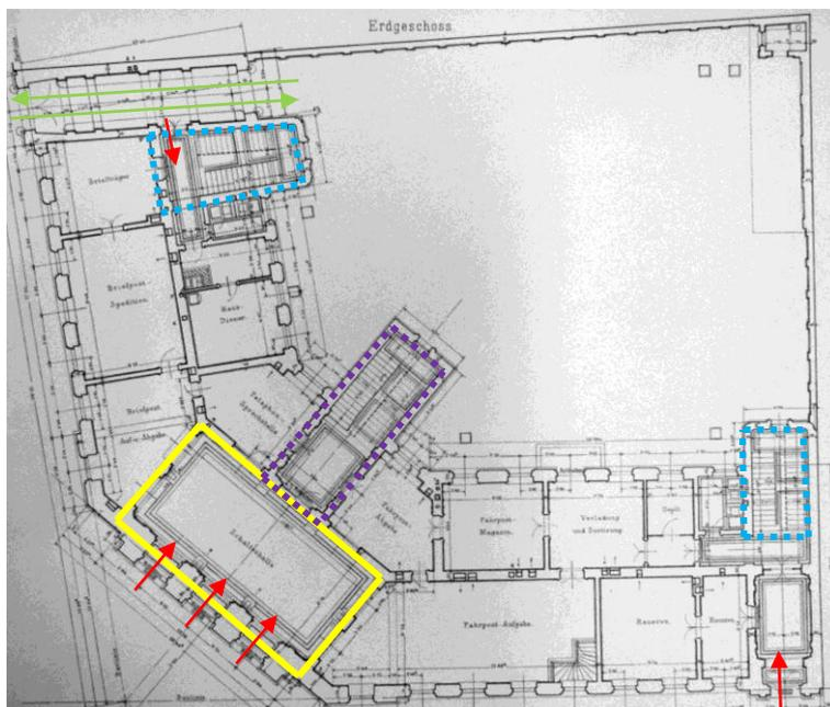
Abbildung 115 Erdgeschoss des Postgebäudes in Cilli [gelb: Schalterhalle/ lila: Haupttreppe/ blau: NebenTreppen/ rote Pfeile: Eingänge/ grüne Pfeile: Einfahrt in den Posthof]
