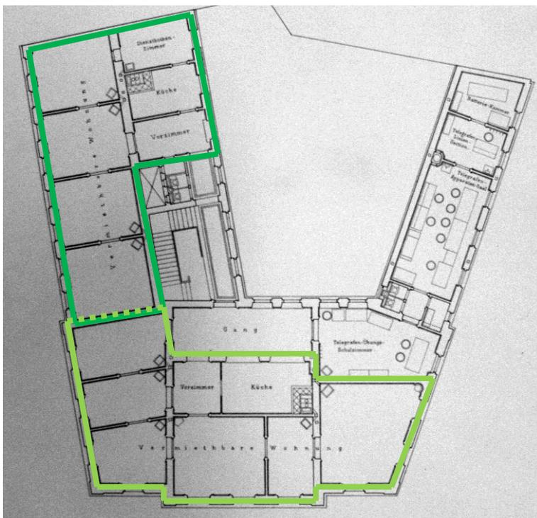
Abbildung 37 Betriebsgebäude in Olmütz 2. Obergeschoss; **hellgrün** und **dunkelgrün** sind die beiden Mietwohnungen gekennzeichnet; der restliche Teil wurde für den Telekommunikationsbereich genutzt
