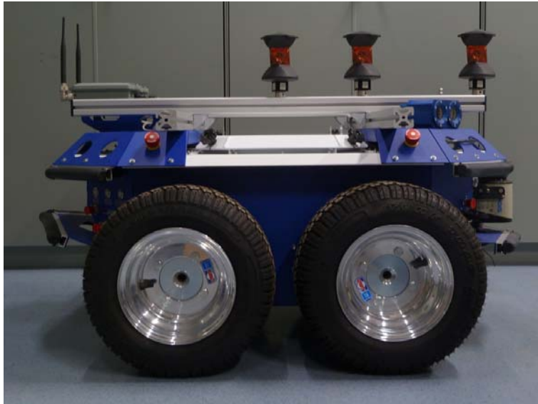
Abb. 7.16: Seekur Jr mit dem an drei Stellen befestigten Rundumprisma: Mitte, über der Vorderachse und vorne (Fotomontage)
