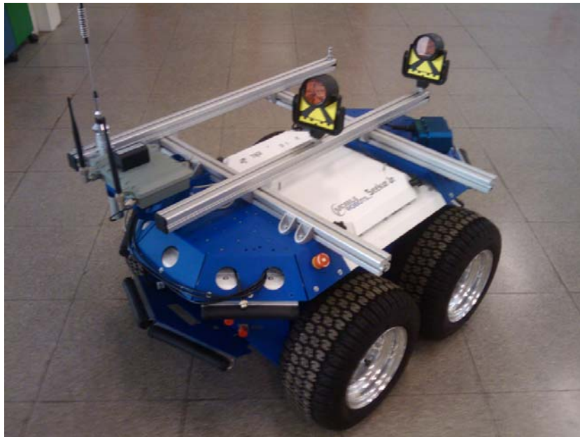
Abb. 7.1: Roboter mit zwei Leica Standard-Rundprismen zur Überprüfung des mathematischen Modells
