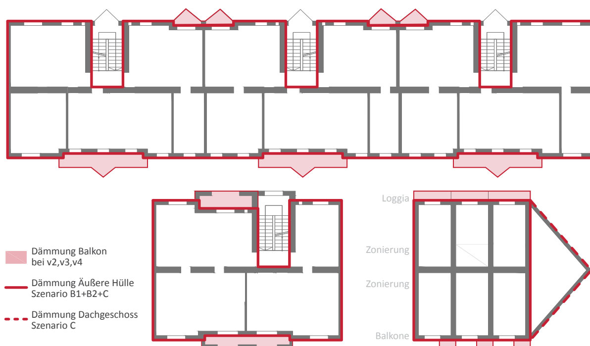
Fig. 44: Konzept der Äußeren Hülle für Heizwärmebedarf-Berechnungen
