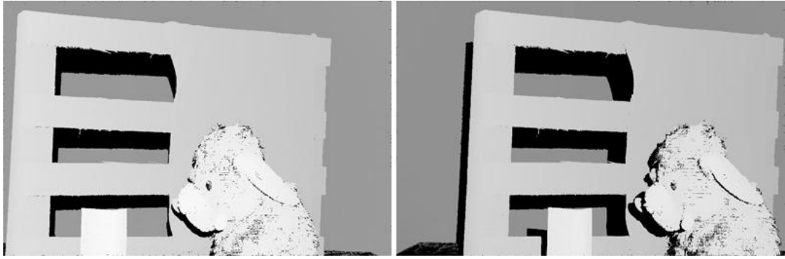
Abbildung 3.10: Beleuchtungsdisparitäten Berechnete Beleuchtungsdisparitäten für linkes und rechtes Stereobild. Schwarze Bereiche zeigen undefinierte Codewerte.
