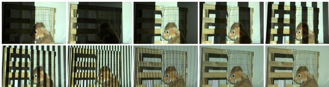
Abbildung 3.7: Graycode Aufnahmesequenz Darstellung einer kompletten Aufnahme sequenz für das linke Stereobild mit vertikalem Streifenmuster.
