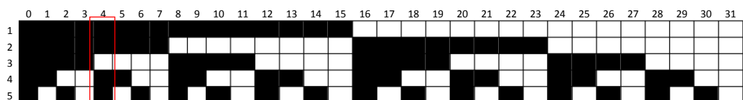
Abbildung 2.18: Binärcode Sequenz Veranschaulicht eine 5 Bit Binärcode Sequenz auf 32 Spalten (oben). Decodierungsfehler im beispielsweise höchstwertigsten Bit (MSB) erzeugen 2^{n-1} (hier maximal 2^4 = 16 ) Codewertfehler.
