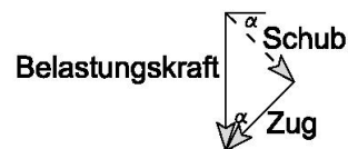
Abb. 2-3: Mögliches Krafteck in der Bruchfuge [22]
