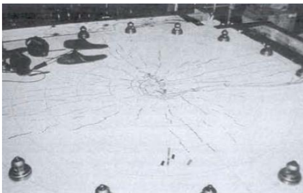
Abb. 2-5: Bruchbild des Durchstanzversuches [2] Abb. 2-6: Rissbild des Durchstanzversuchs [2]
