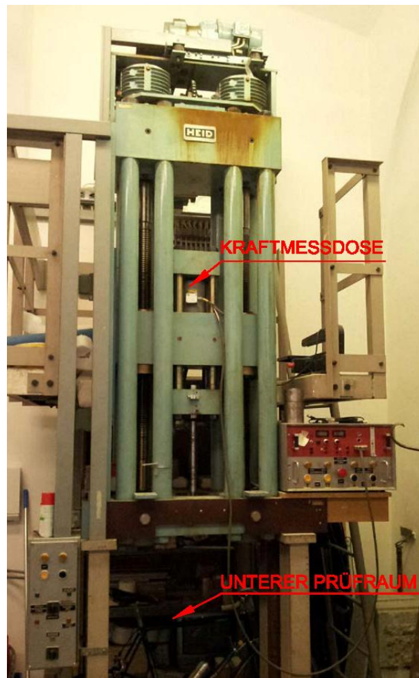
Abb. 3-47: Prüfmaschine, Position der Kraftmessdose
