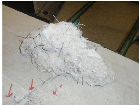
Abb. 4-21: Durchstanzkegel der Probe P 005
