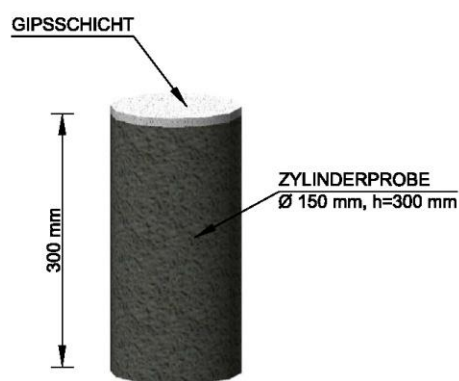
Abb. 3-1: Geometrie der Zylinderproben
