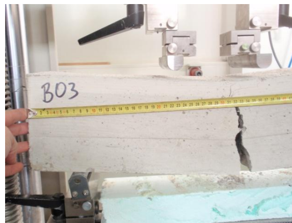
Abb. 3-31: Rissbild Probe B 03
