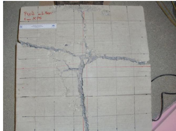
Abb. 4-28: Rissbild Plattenunterseite P 007
