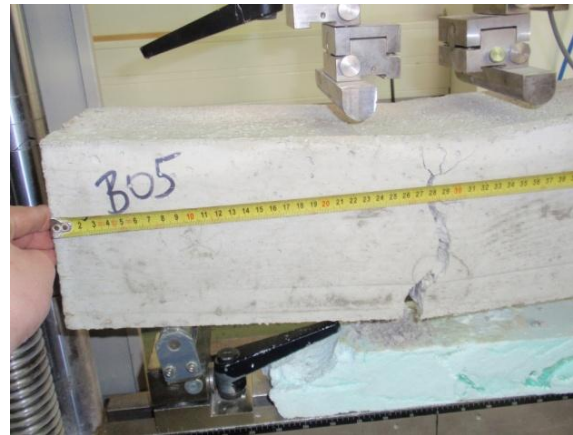
Abb. 3-35: Rissbild Probe B 05
