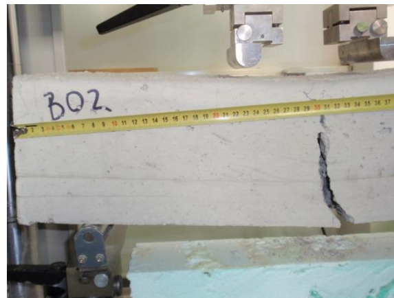
Abb. 3-29: Rissbild Probe B 02
