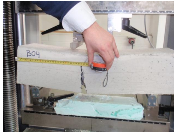
Abb. 3-33: Rissbild Probe B 04
