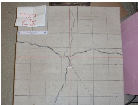
Abb. 4-29: Rissbild Plattenunterseite P 008
